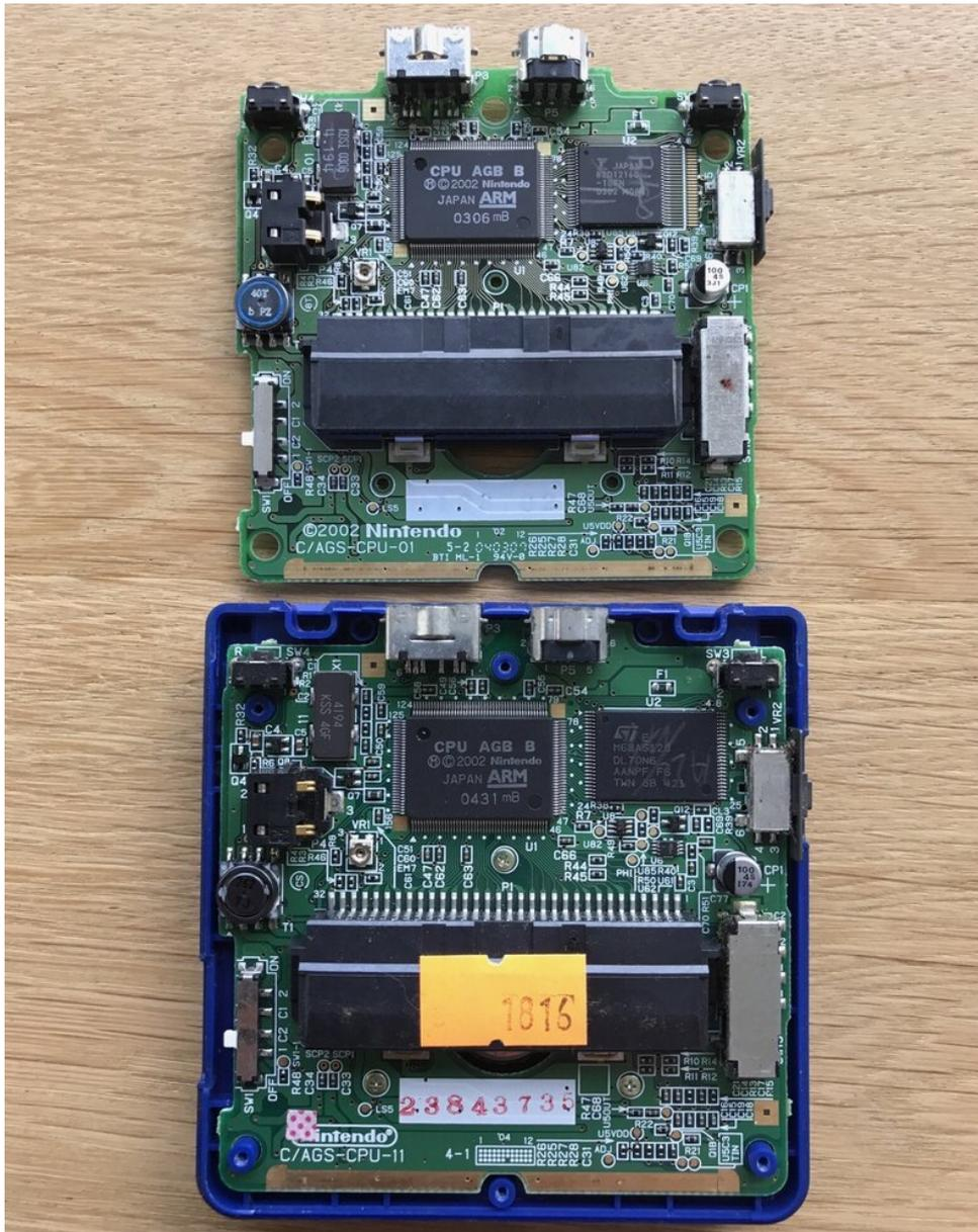
*Finde die Unterschiede: die originale fehlerhafte Hauptplatine oben und der Ersatz unten*
