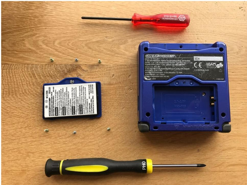
*Ordnen Sie die Schrauben um etwas leicht Erkennbares (den Akku) an, um leicht den Überblick zu behalten, wohin die (verschiedenen) Schrauben gehören*
