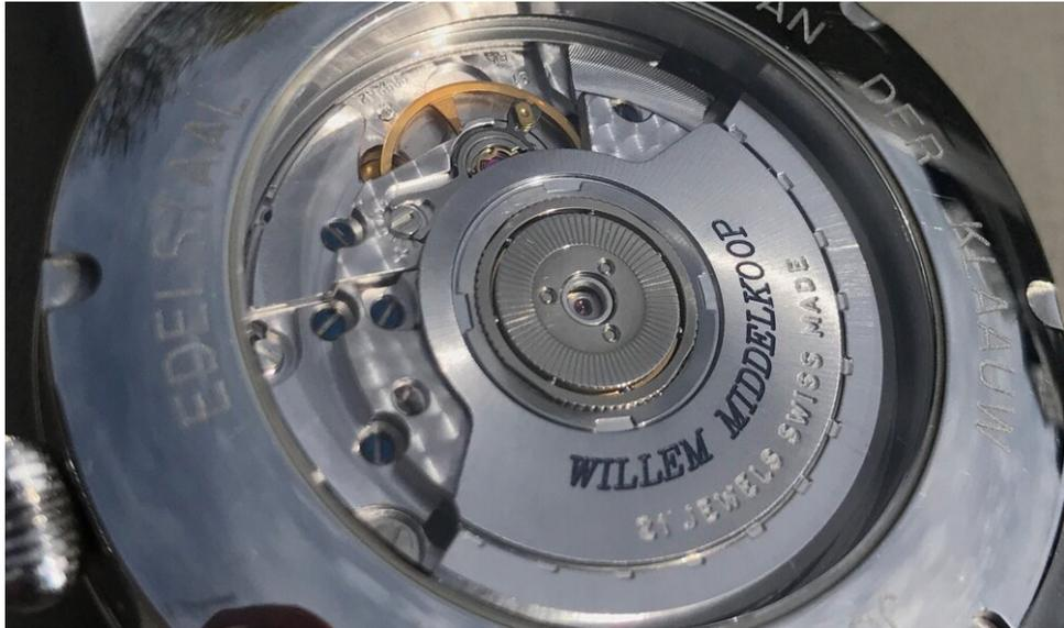
*Der Aufzugsrotor und das Uhrwerk der mechanischen Uhr, sichtbar durch den Saphirglasboden*
