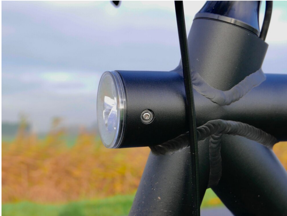
Frontlicht ist in den Rahmen integriert
