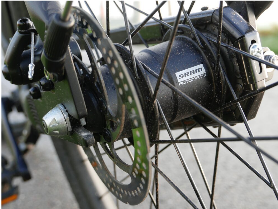
SRAM Automatix Zweigang-Nabenschaltung - man hasst sie oder man liebt sie
