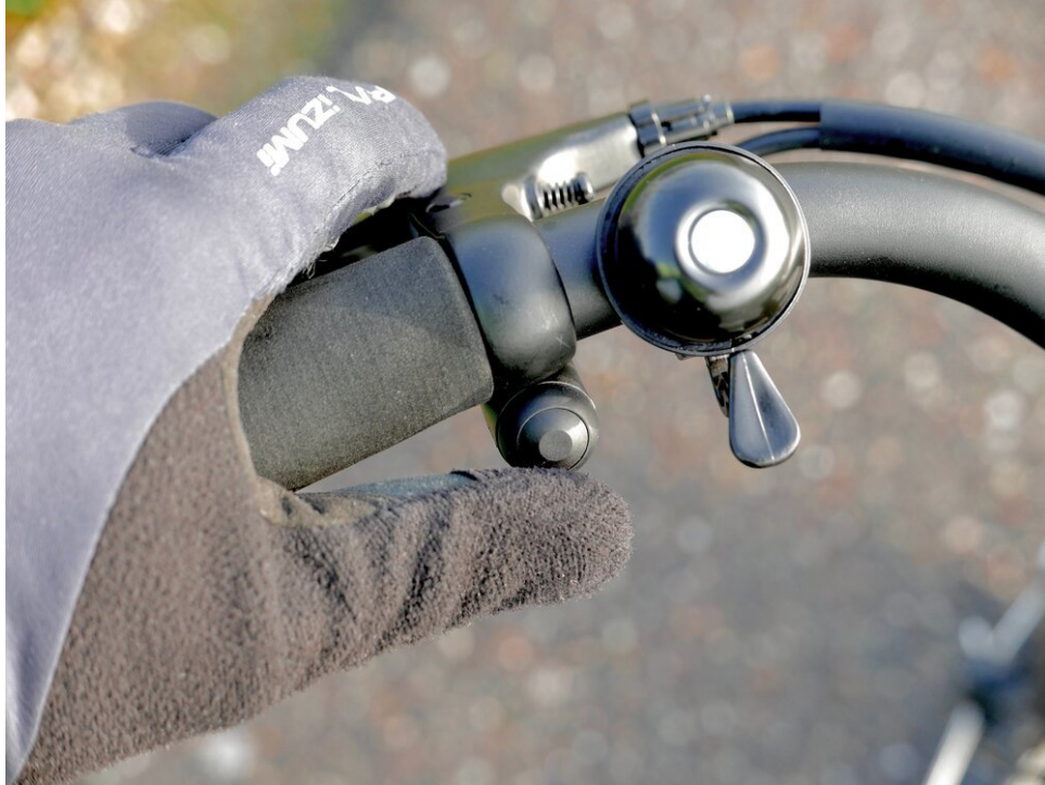
Der Boost-Knopf, bequem in der Nähe des linken Daumens positioniert
