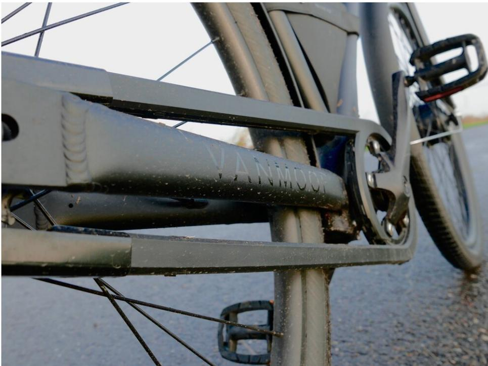
*Kettenschutz aus flexiblem Kunststoff ist widerstandsfähig gegen Beschädigungen*
