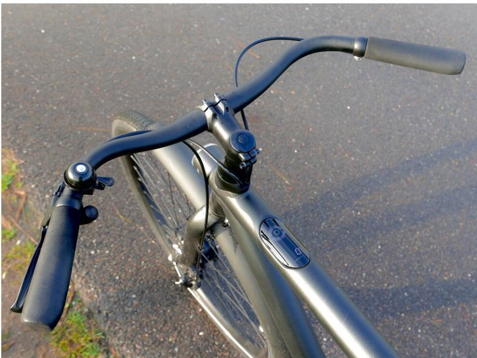
*Das Fahrrad verfügt über eine sportliche City-Lenkung und einen integrierten Touchscreen im Rahmen*
