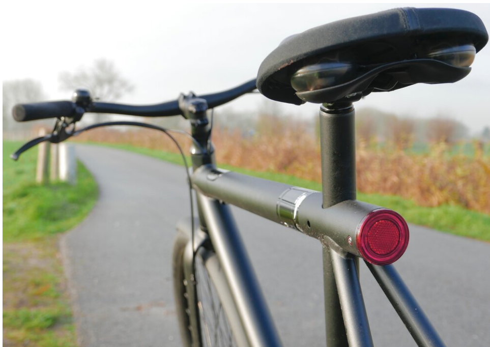
Rücklicht ist unter der Sattelstütze integriert
