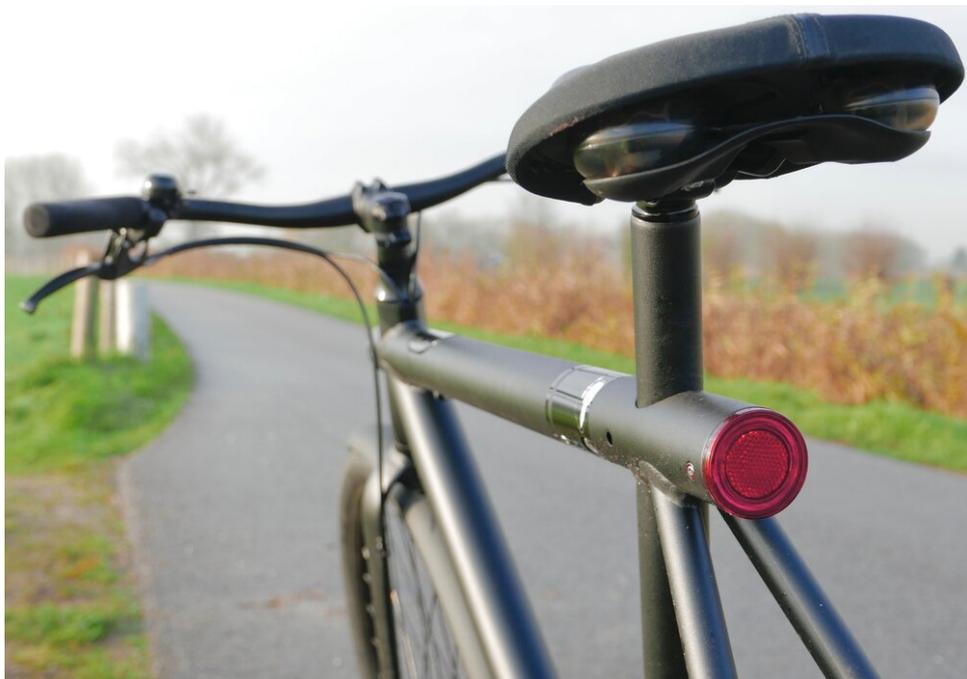
*Rücklicht ist unter der Sattelstütze integriert*
