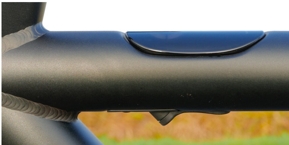
Dashboard und Ladeanschluss sind in den Rahmen integriert
