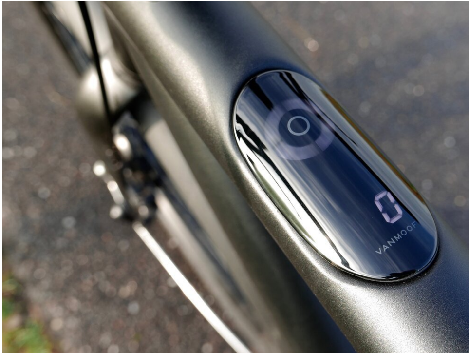
Das Dashboard zeigt die aktuelle Geschwindigkeit, den Akkustand und die Motorleistung an
