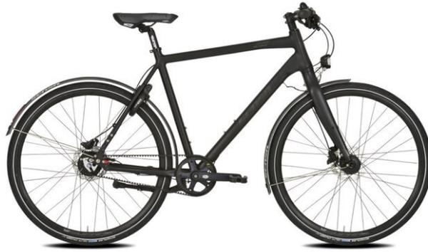
*ILU integriertes Licht am Sensa Cintura Riemenantriebsfahrrad - es wird nicht durch Gepäck, Kindersitze oder eine lange Jacke blockiert*
