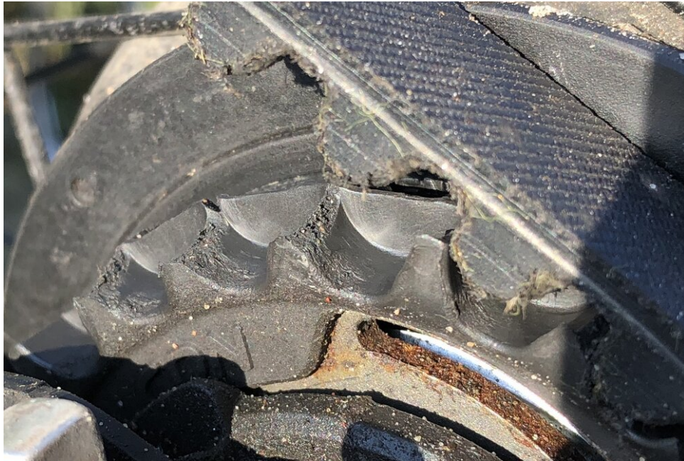
Gates Carbon Drive hinteres Kettenrad mit übermäßigem Verschleiß nach nur 1800 km
