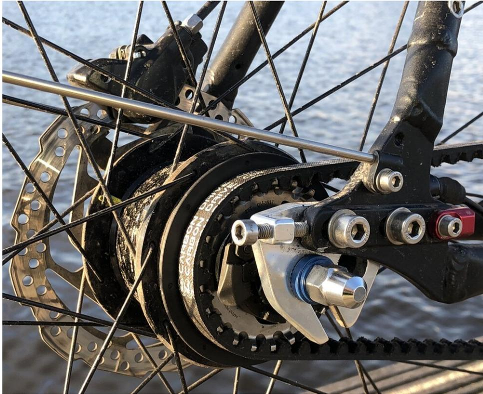
*Das Gates CDX-Hinterradkettenrad montiert*
