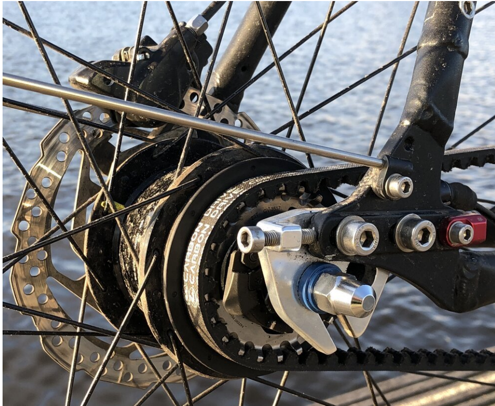
Das Gates CDX-Hinterradkettenrad montiert
