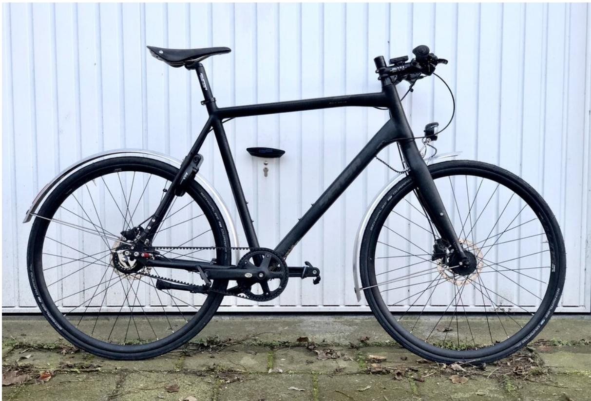
Diesen Winter nutze ich ein Sensa Cintura Fahrrad mit Gates Carbon Riemenantrieb als mein tägliches Pendlerad. Es ist ein Fahrrad, das dank seines sportlichen, leichten Rahmens angenehm zu fahren ist. Es ist außerdem auf geringen Wartungsaufwand ausgelegt, dank des Riemenantriebs und der Nexus Aflin 8 Nabenschaltung. Nach 1800 km in nur acht Wochen war es Zeit für ein paar Upgrades.
