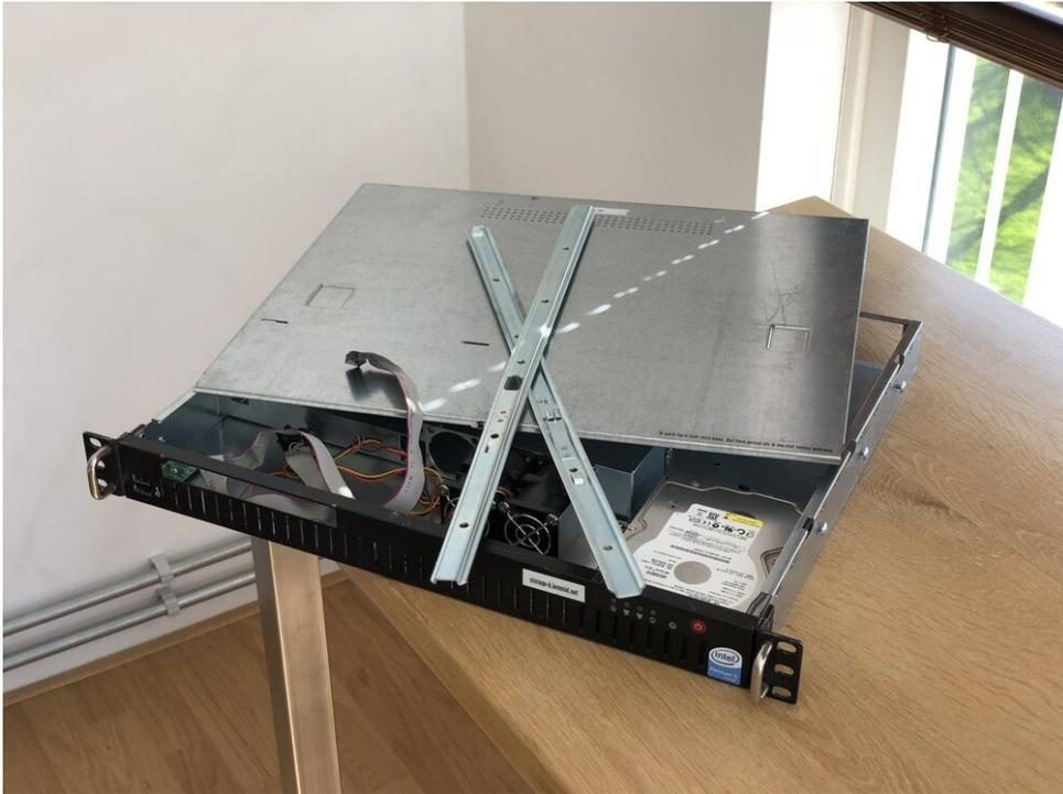
*Rack-montiertes Servergehäuse (1U), mit Schienensatz*
