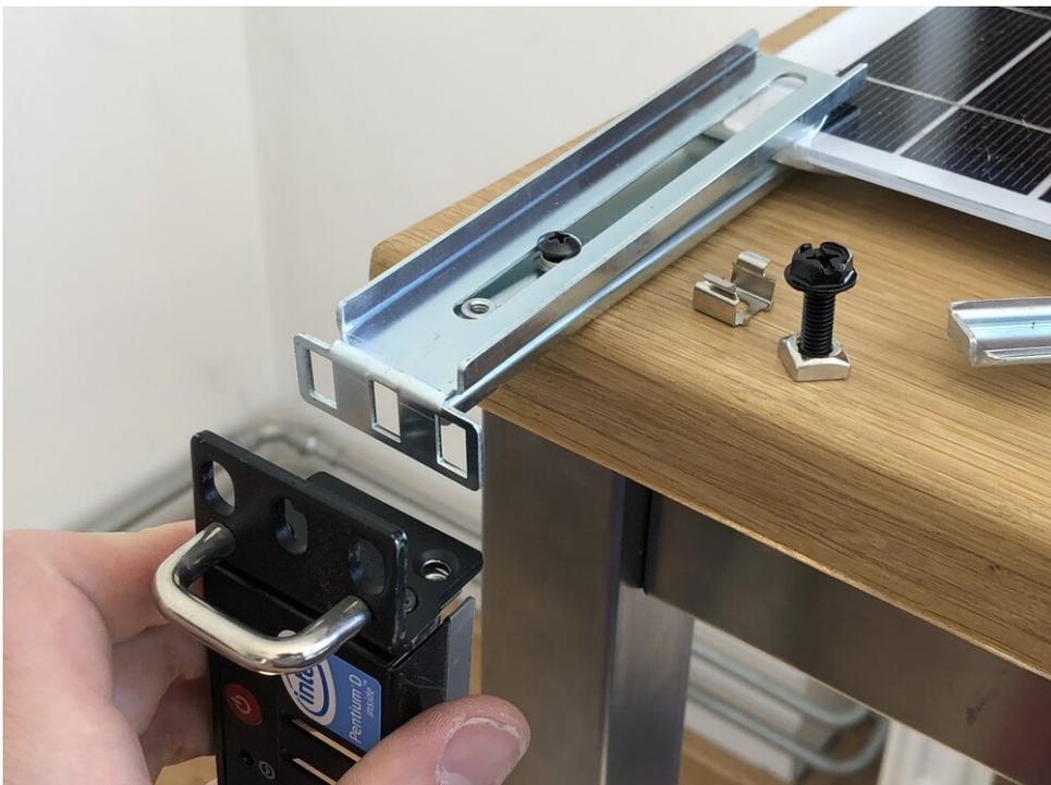
*Einst die Vorderseite eines Servers, jetzt Teil der Solarpanel-Halterung*
