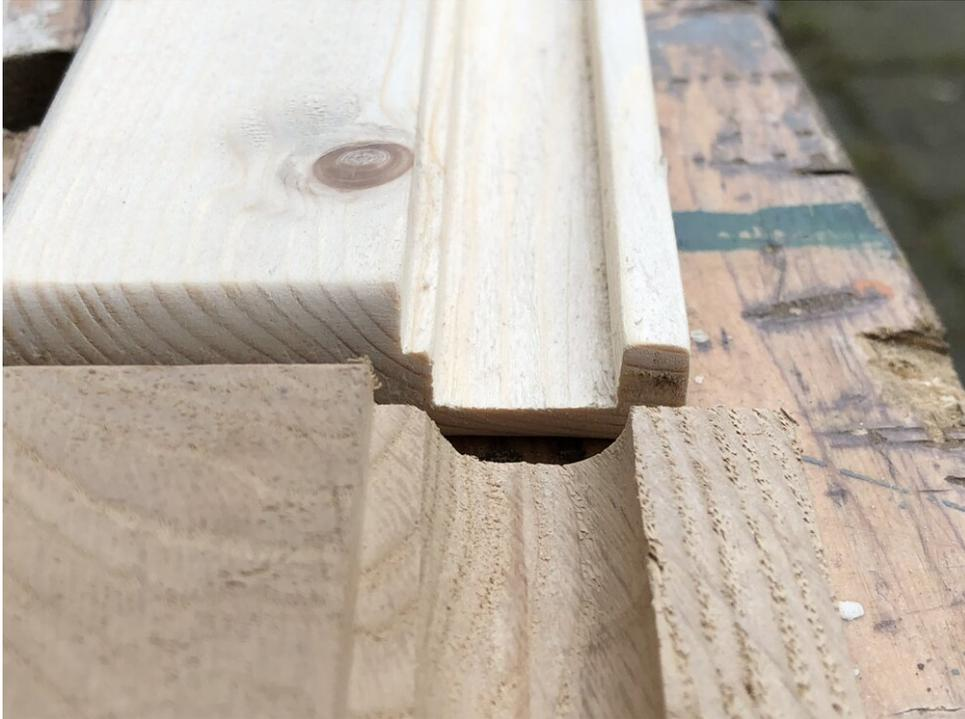
*Vergleich des Fräsprofils von Prototyp und finaler Version*
