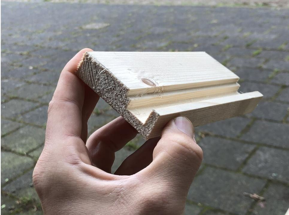
*Prototyp aus Fichtenholz zur Bestimmung des Fräsprofils*
