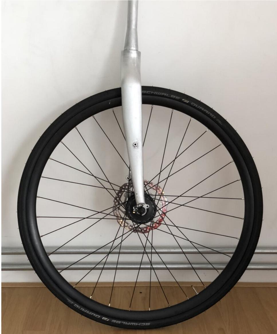
*Vorderrad an der rohen Aluminiumgabel montiert*
