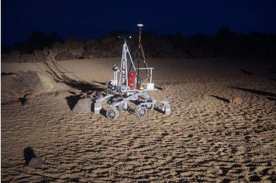
*Der schnelle Heavy Duty Planetary Rover (HDPR) der ESA am Teide (Bildnachweis: ESA)*
