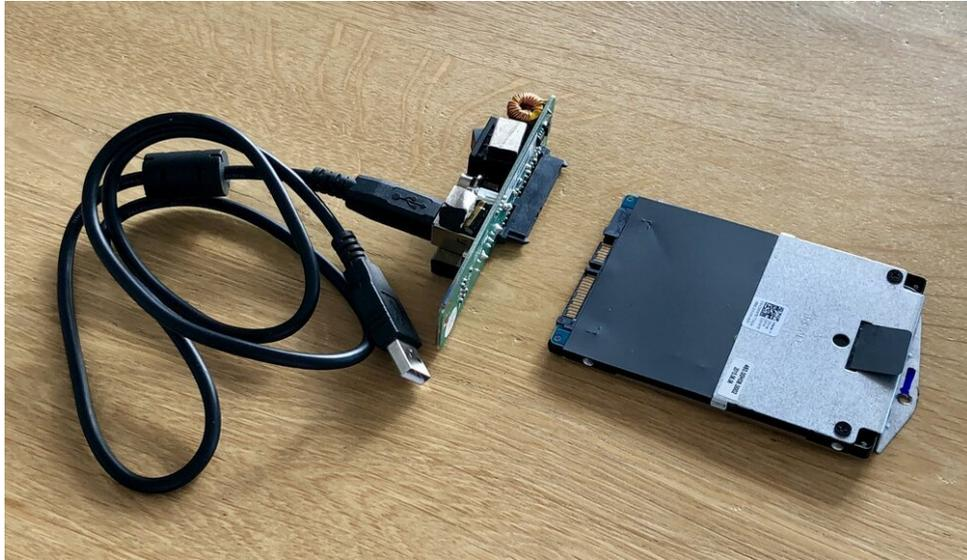
*Anschließen einer beliebigen Festplatte an einen Computer mithilfe des Chips und der Kabel eines USB-Festplattengehäuses*
