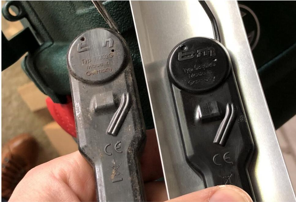
*Busch und Müller Rücklicht in den hinteren Schutzblech montiert, zeigt Abnutzungerscheinungen durch Spritzwasser vom Hinterrreifen*
