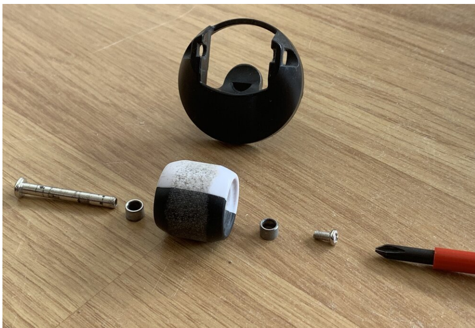
Vorderrad reinigt die Lager
