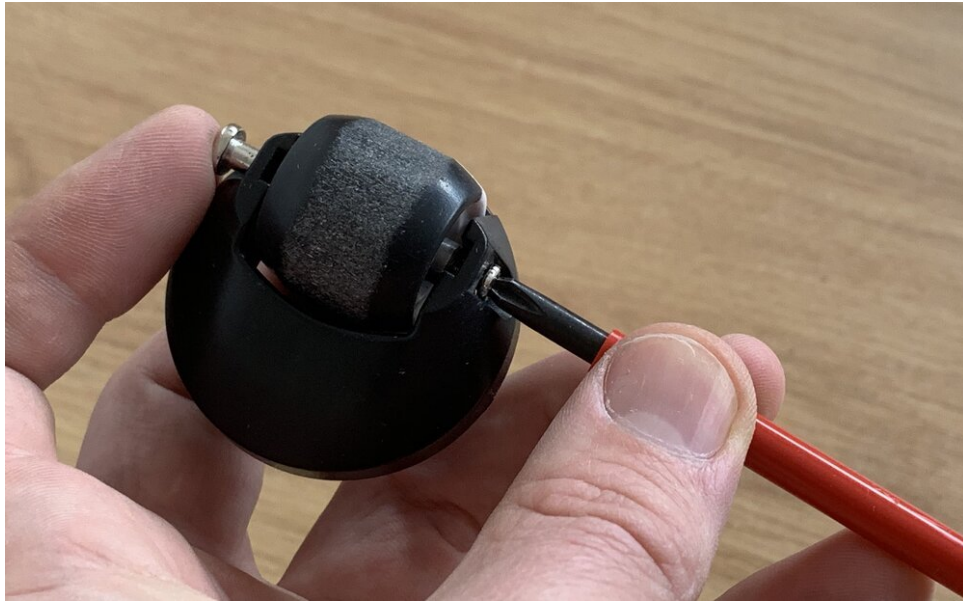
Vorderradersatz mit einer Schraubbefestigung
