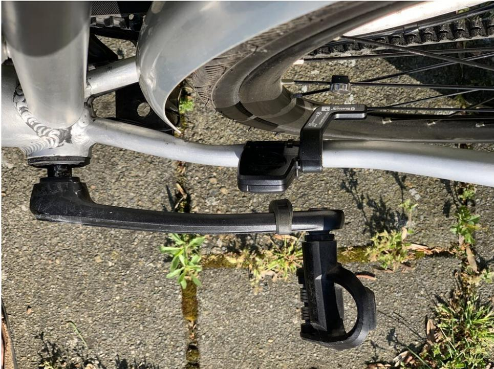
*Der kombinierte Geschwindigkeits- und Trittfrequenzsensor an meinem Fahrrad montiert*
