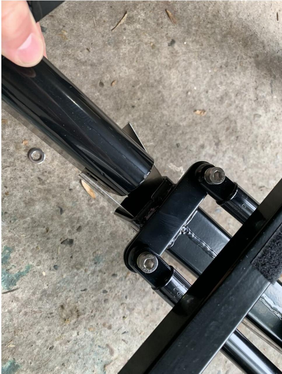
*Einquetschen der Füllplatten beim Verbinden des hinteren und vorderen Rahmens*
