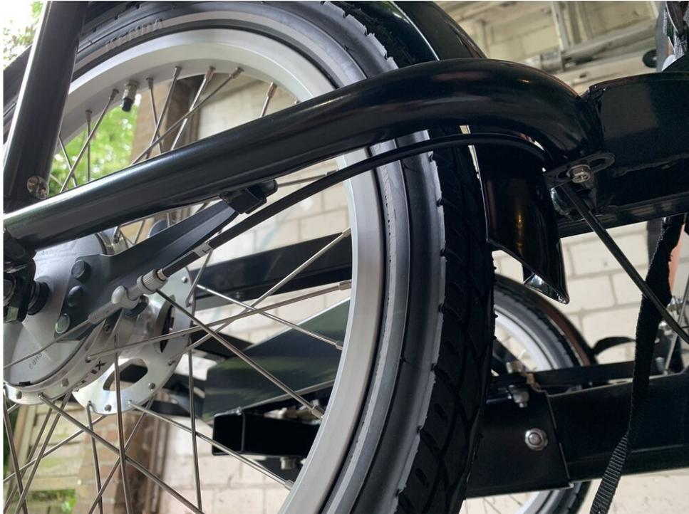
*Saubere Kabelführung: Ich habe die Schraube des Schutzblechs wiederverwendet, um das Bremskabel zu befestigen*
