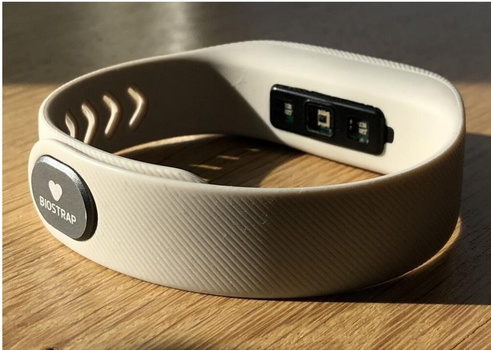
*Biostrap verfügt über einen optischen Sensor, der sich in der Mitte zwischen zwei LEDs befindet*
