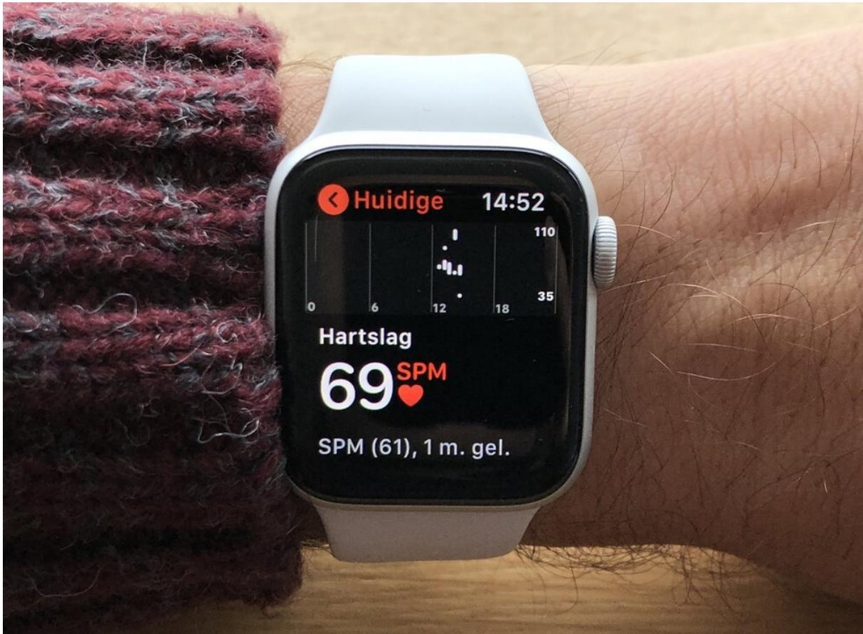
Mit modernen Wearables, Smartwatches und Fitnessarmbändern ist es einfach und üblich geworden, die Herzfrequenz zu messen. Es gibt jedoch grundlegende Unterschiede bei den Sensortypen. Einige Sensoren erfassen das elektrische Signal des Herzens, während andere Licht verwenden, um den Blutfluss durch die Gefäße zu analysieren. Wenn Sie sich für die Messung der Herzfrequenz interessieren, ist es gut, diese Unterschiede zu verstehen.
