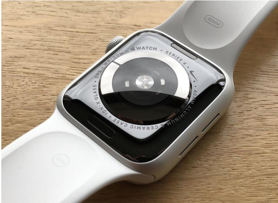
*Die Apple Watch verfügt über einen optischen Herzfrequenzsensor, der deutlich in der Mitte der Unterseite sichtbar ist*
