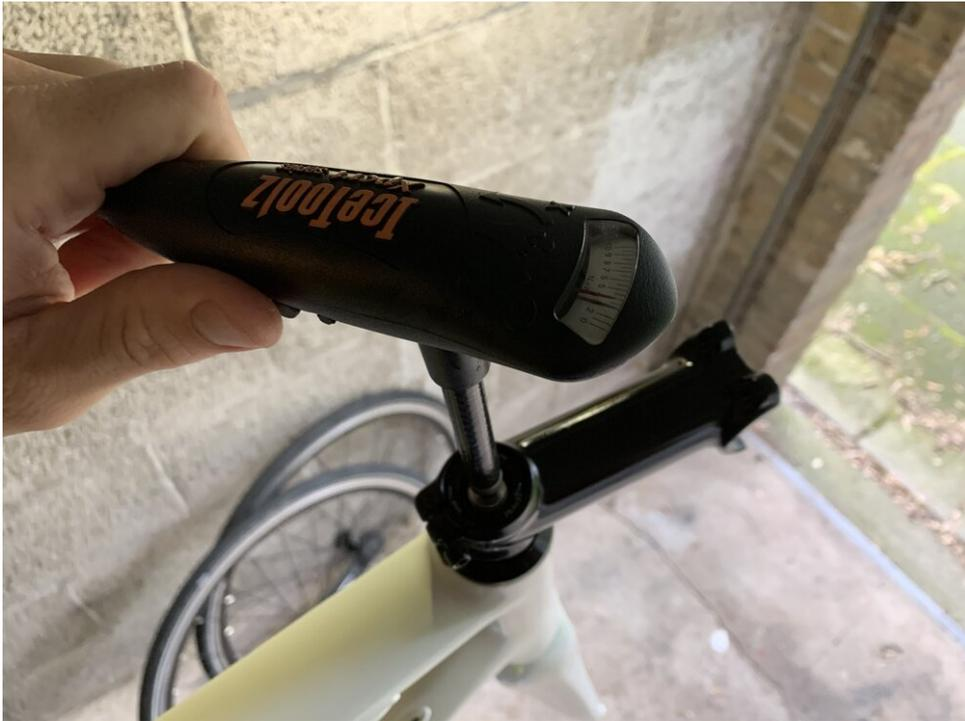
*Verwenden Sie immer einen guten Drehmomentschlüssel, um übermäßige Kraft auf Schrauben zu vermeiden*
