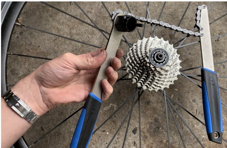
*Verwenden Sie ein Kassettenwerkzeug und/oder eine Kettenpeitsche, um die Kassette zu montieren oder zu demontieren*
