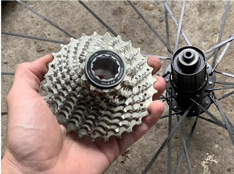
*Die Kassette lässt sich einfach montieren, wenn Sie sie auf das Muster der Hinterachse ausrichten*
