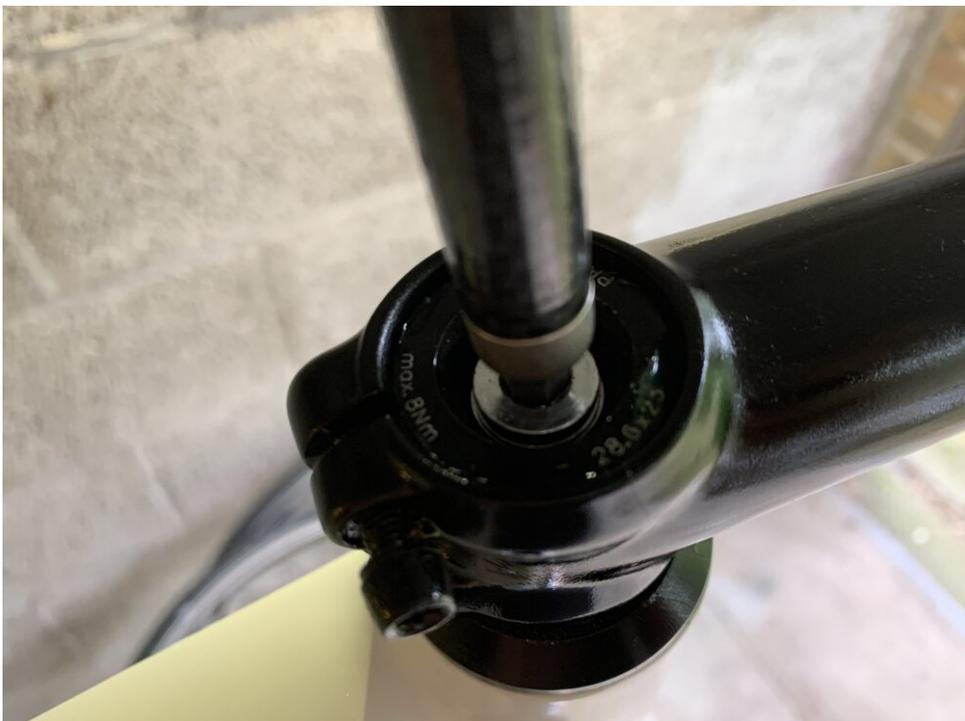
*Die meisten Teile haben Drehmomentwerte in Newtonmeter (Nm) aufgedruckt*
