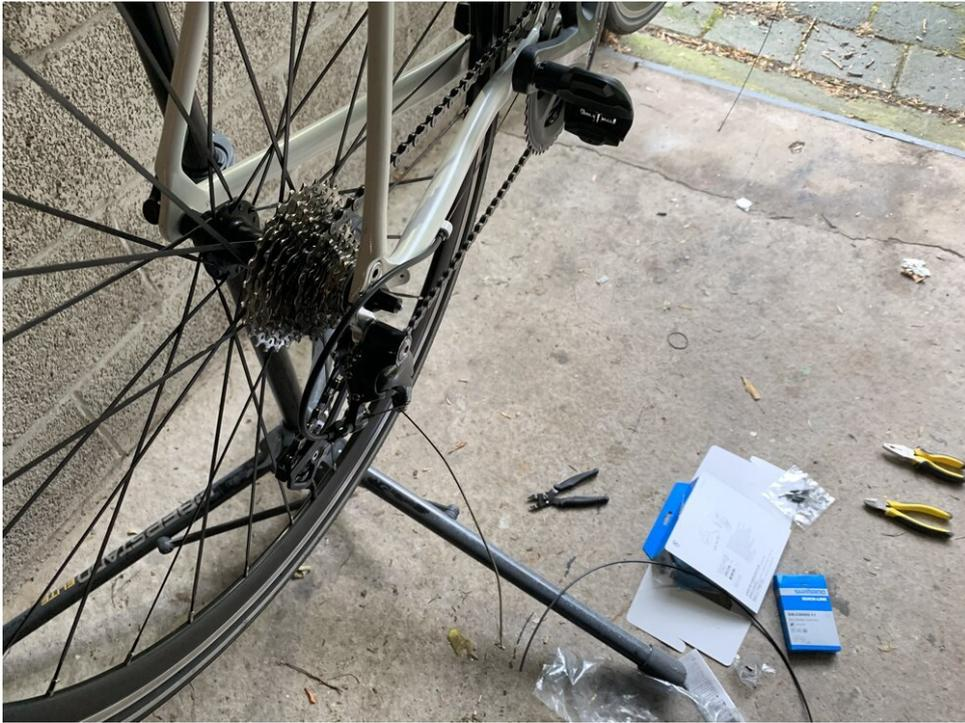
*Züge an den Schaltwerken anschließen*
