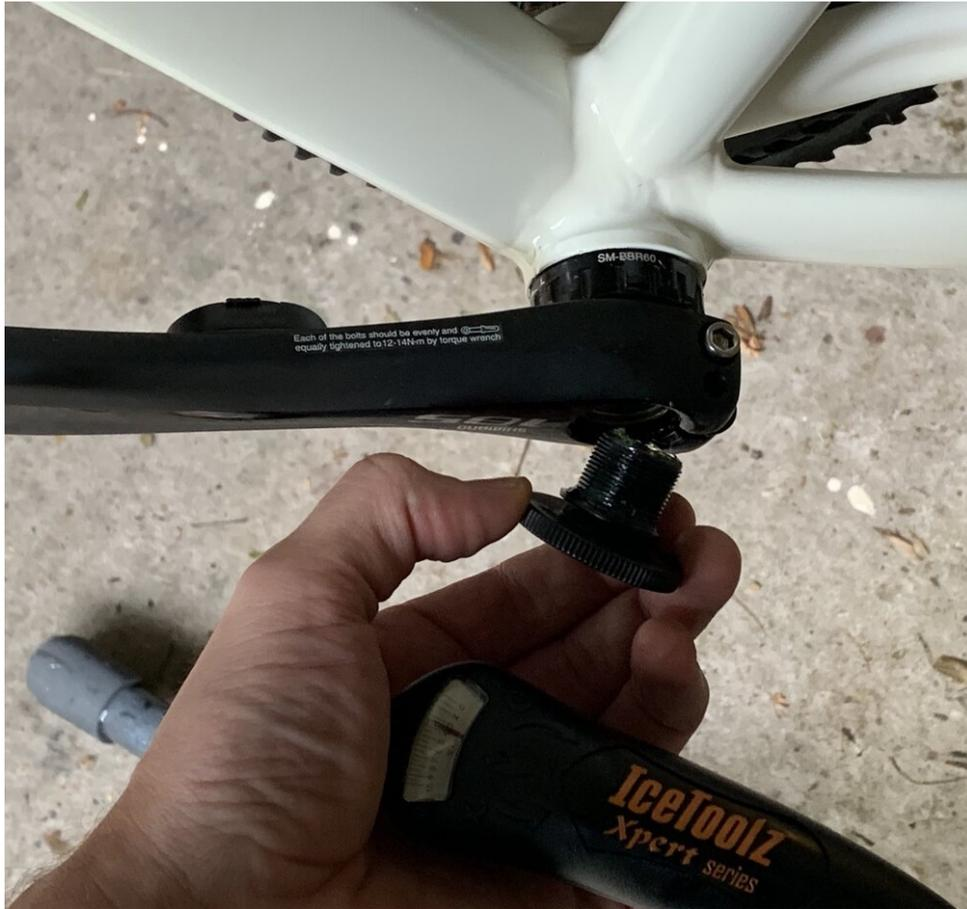
*Installation der Kurbel mit einem Drehmomentschlüssel und Kurbelwerkzeug - beachten Sie die schriftlichen Anweisungen auf der Kurbel*
