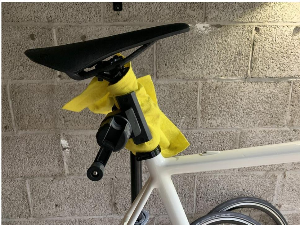
*Das Sattelrohr ist ein guter Ort, um Ihr Fahrrad im Montageständer zu befestigen*
