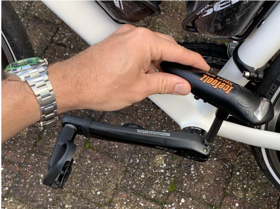
*Anziehen des Kurbelarms mit einem Drehmomentschlüssel*
