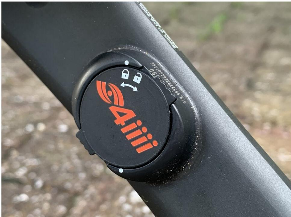
*Stellen Sie sicher, dass die Batterie eingelegt und die Abdeckung verriegelt ist*
