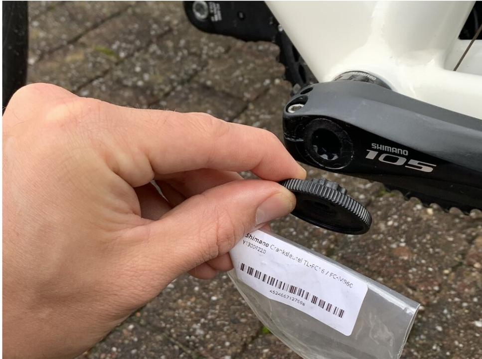
*Kurbel mit einem Kurbelwerkzeug entfernen (Shimano TL-FC16 / FC-M960)*
