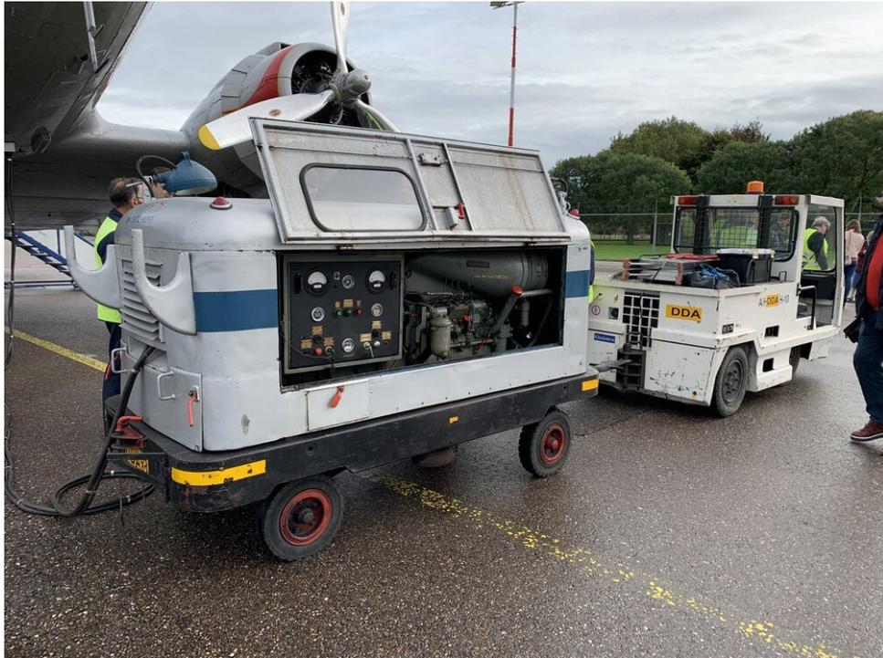
*Elektrischer Generator, angetrieben von einem in Deutschland gebauten Deutz-Dieselmotor, zum Starten der R-1830-Motoren*
