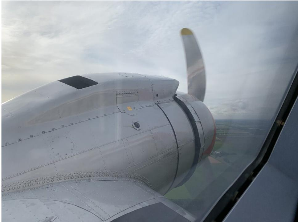
*Der R-1830 Twin Wasp Kolbenmotor bei der Arbeit - er fühlt sich lebendig an!*
