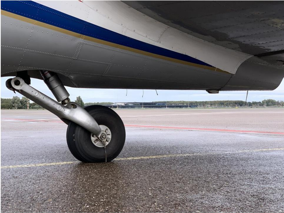
*Das Spornrad der C-47-A PH-PBA ist ziemlich nah am Boden, wenn sie auf der Plattform geparkt ist*
