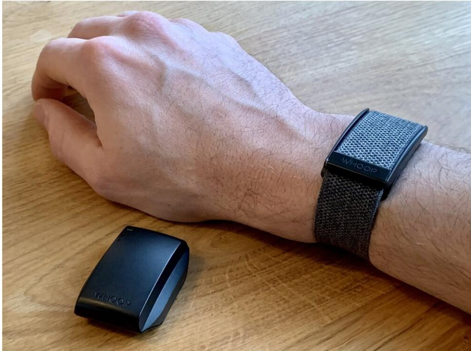
*Der WHOOP Strap wird mit einem aufschiebbaren Akkupack geladen, sodass Sie ihn kontinuierlich tragen können*
