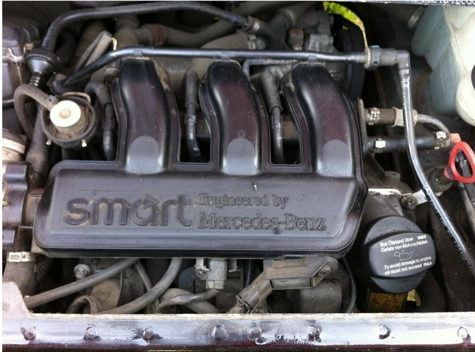
*Mercedes-Benz 3-Zylinder Suprex Motor*
