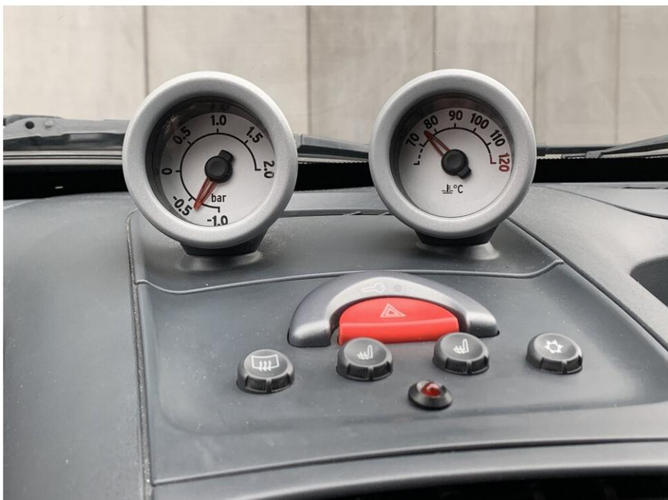
*Extra sportliche Anzeigen im Armaturenbrett: Turbodruck und Motortemperatur*
