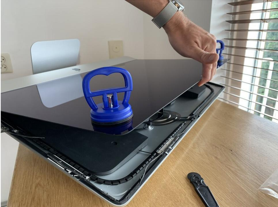
*Vorsicht beim Anheben des Glases, es gibt Kabel, die das Panel mit der Hauptplatine verbinden*
