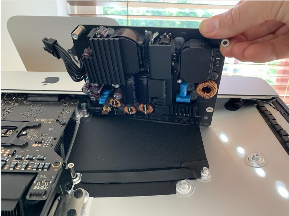
*Entfernen der Netzteilplatine*
