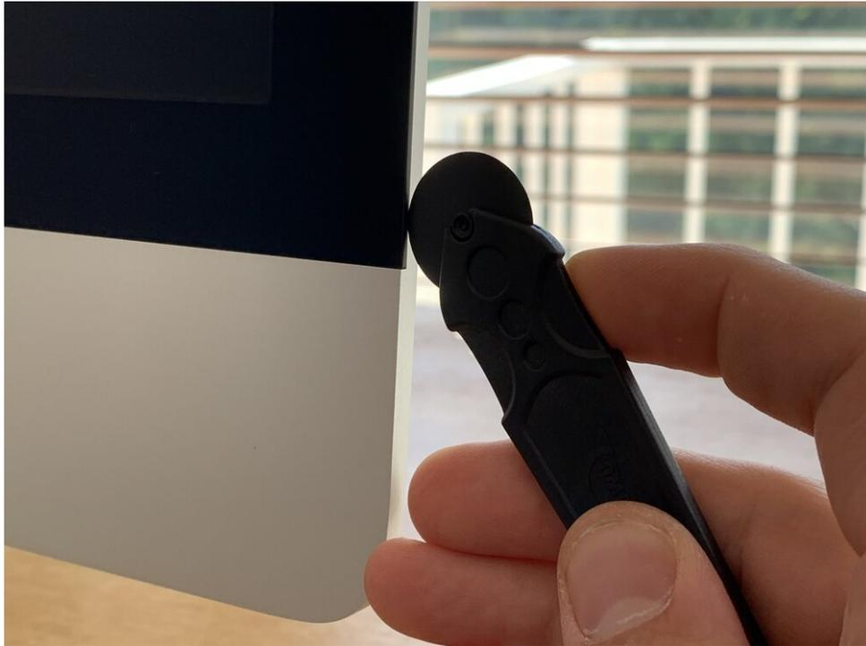
*Mit einer speziellen Rolle wird der iMac aufgeschnitten*
