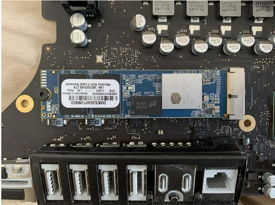
*Das SSD-Laufwerk korrekt installiert, beachte, wie viel tiefer der Anschluss in seiner Buchse sitzt*
