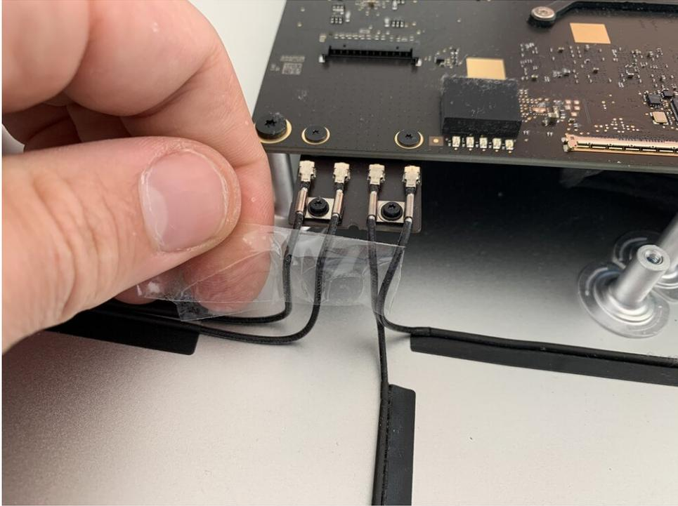
*Entfernen der Antennenkabel, merken Sie sich deren Reihenfolge mit einem Stück Klebeband*
