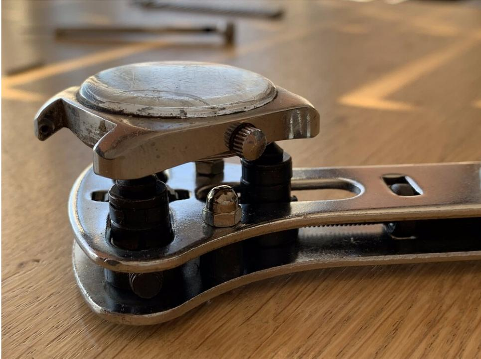
*Stellen Sie das Werkzeug so ein, dass es zu den Befestigungspunkten auf dem Gehäuseboden passt, damit es diesen öffnen kann*
