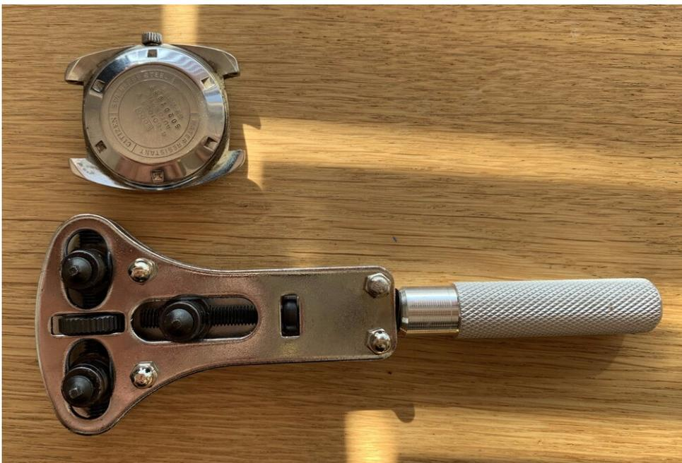
*Das Öffnen der Uhr kann mit einem Spezialwerkzeug erfolgen*
