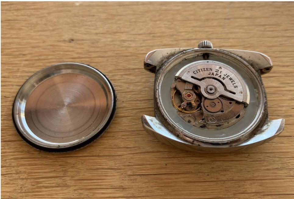
*Sie können den Gehäuseboden drehen und vom Uhrenkopf abnehmen, um das Uhrwerk freizulegen*
