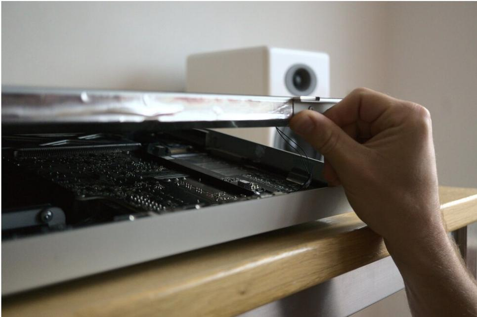
*Vorsicht beim Anheben des Displays, da mehrere Kabel mit dem Main Logic Board verbunden sind*
