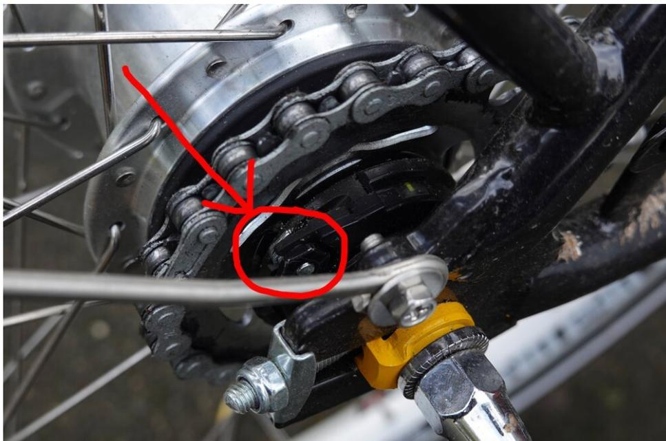
*Die Shimano Nexus 7-Gang Nabenschaltung - der Zug wird mit einer Schraube befestigt, innerhalb des roten Kreises*
