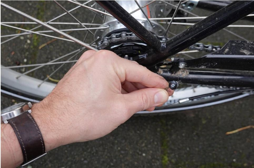
*Die Schraube, die den Schaltzug hält, wurde aus der Halterung an der Nabenschaltung gezogen*
