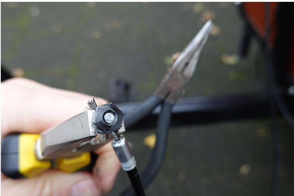
*Das Lösen der Schraube ist einfach mit zwei Zangen zu bewerkstelligen*
