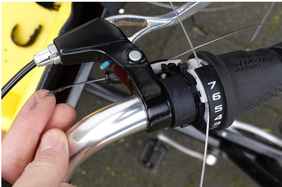
*Ziehen Sie das beschädigte Kabel ganz heraus*
