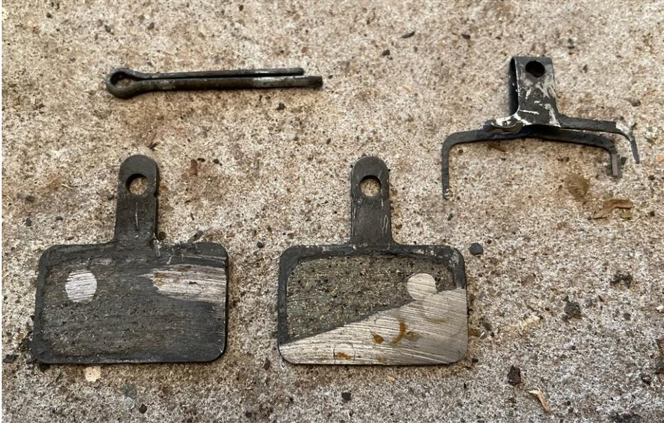
*Meine hydraulischen Bremsbeläge waren abgenutzt! Beachtet die beschädigte Gabel oben rechts (die die Beläge an Ort und Stelle halten soll)*
