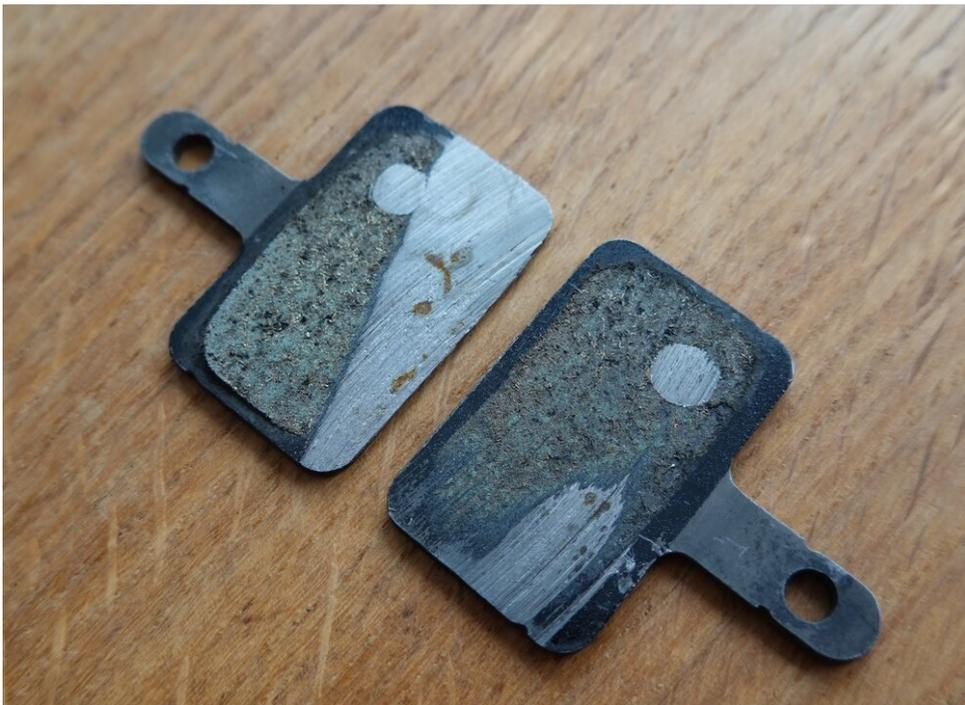
*Nach etwas Reinigung kann man deutlich sehen, wie 21.000 km auf einem Satz Bremsbelägen aussehen!*
