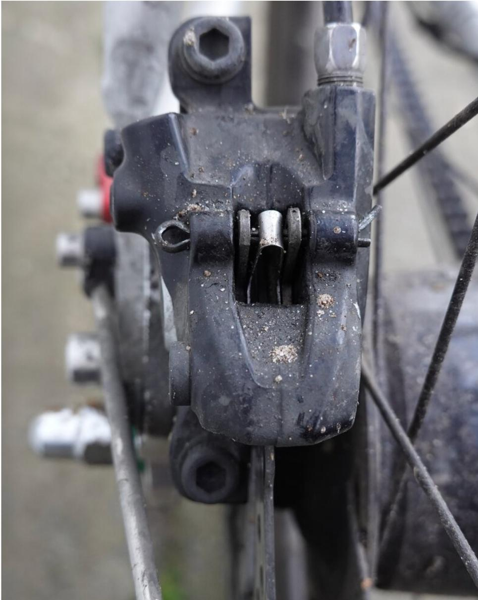
*Neue Bremsbeläge eingebaut*
