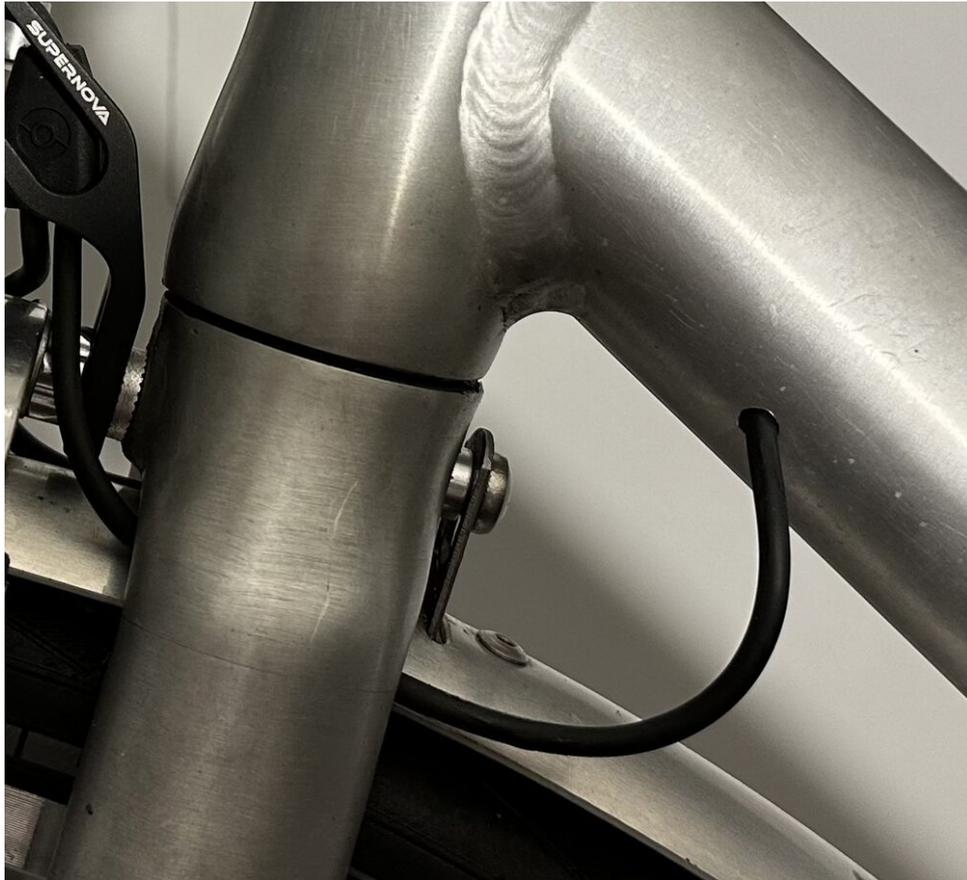
*Das Kabel zum Rücklicht verläuft innerhalb eines neu gebohrten Lochs in meinem Fahrradrahmen - so bleibt gerade genug Kabel übrig, damit sich mein Lenkrad drehen kann*
