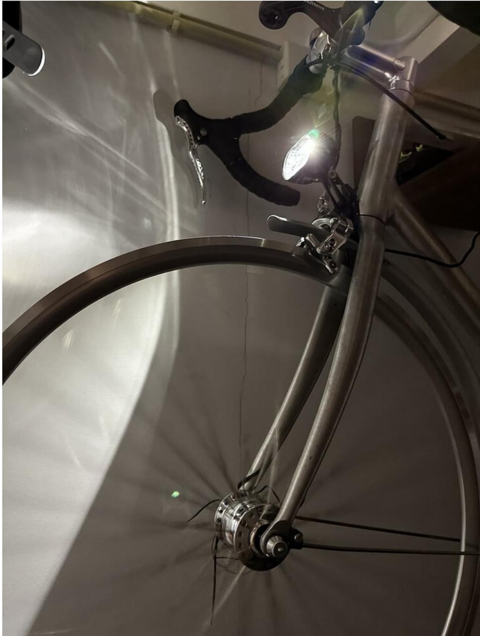
*Test der dynamobetriebenen Beleuchtung mit einigen schnell angeschlossenen losen Kabeln
