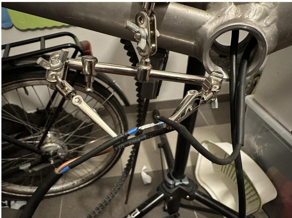
*Verlöten der einzelnen Leitungen und Schrumpfen der Lötstellen*
