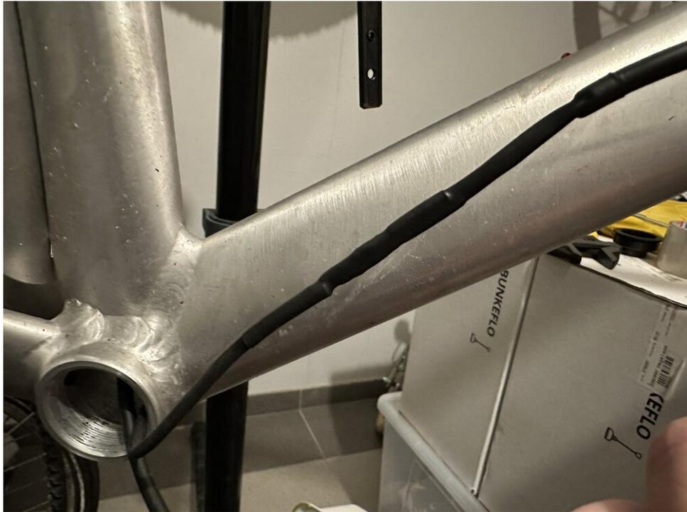
*Die entstandene Schrumpfverbindung ist sowohl funktional als auch langlebig*
