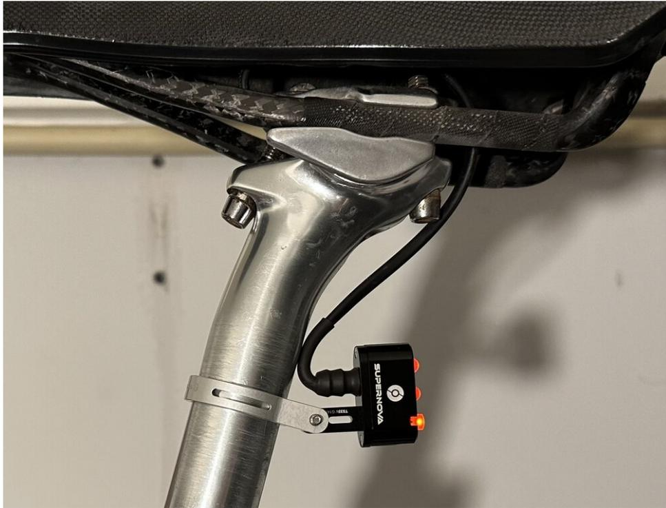
*Das Rücklicht ist an meiner Sattelstütze montiert, das Kabel verläuft im Inneren der Sattelstütze*
