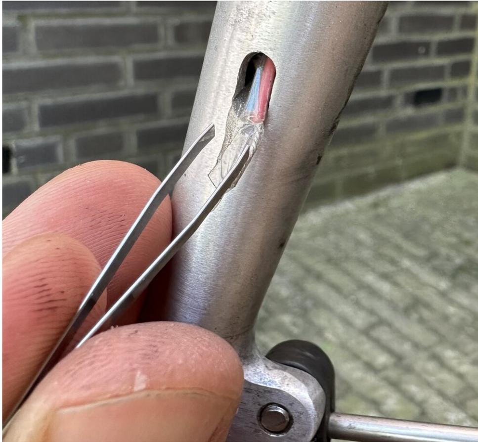
*Mit einer Pinzette gelang es mir schließlich, den Draht durch die winzigen Löcher in meiner Vorderradgabel zu führen*
