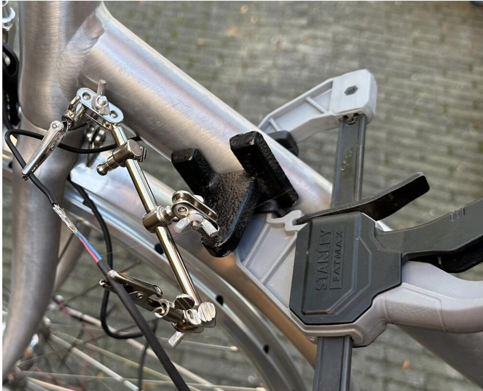
*Vorübergehendes Anlöten der eigentlichen Kabel an ein Kupferführungskabel, um das Durchziehen durch den Fahrradrahmen zu ermöglichen*
