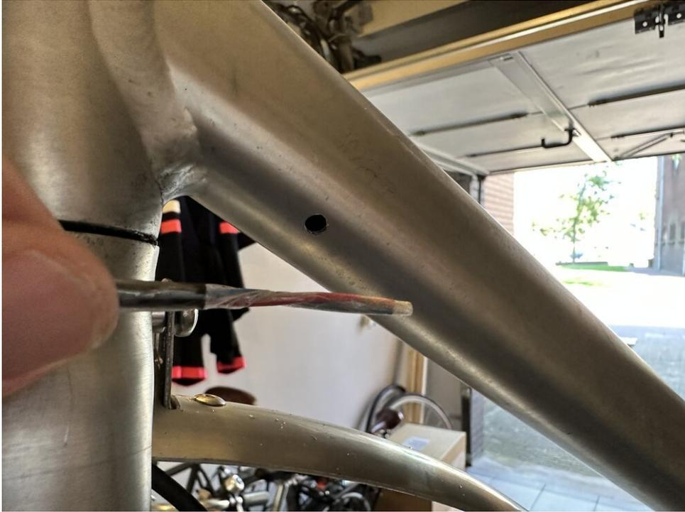
*Verwenden Sie eine dünne Schicht Klebeband, um die einzelnen Leitungen vorübergehend zu verbinden - so lässt sich das Kabel leichter führen*
