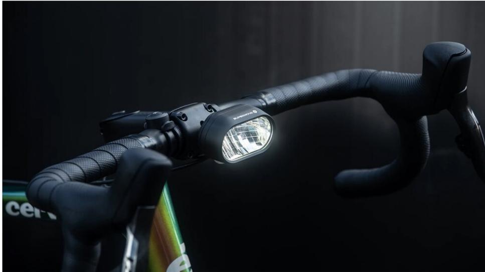
*Der Supernova M99 DY PRO ist ein dynamobetriebener LED-Scheinwerfer mit Fernlichtfunktion und deutscher Straßenzulassung*
