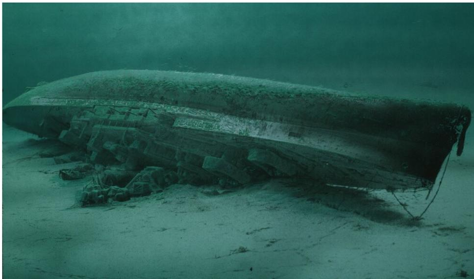
*Stahl in alten Schiffswracks wird für seine Reinheit geschätzt - HMS Royal Oak Meeresboden (Scapa Flow)*
