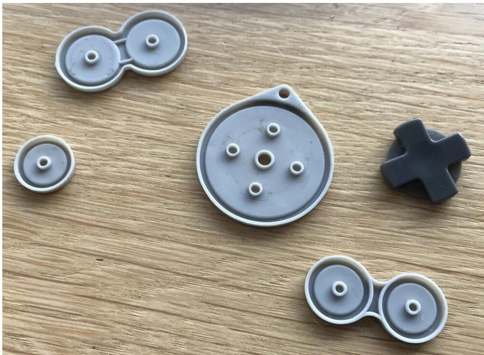
*¡Diseño de hardware inteligente: cada botón encaja exactamente en una sola posición y orientación!*
