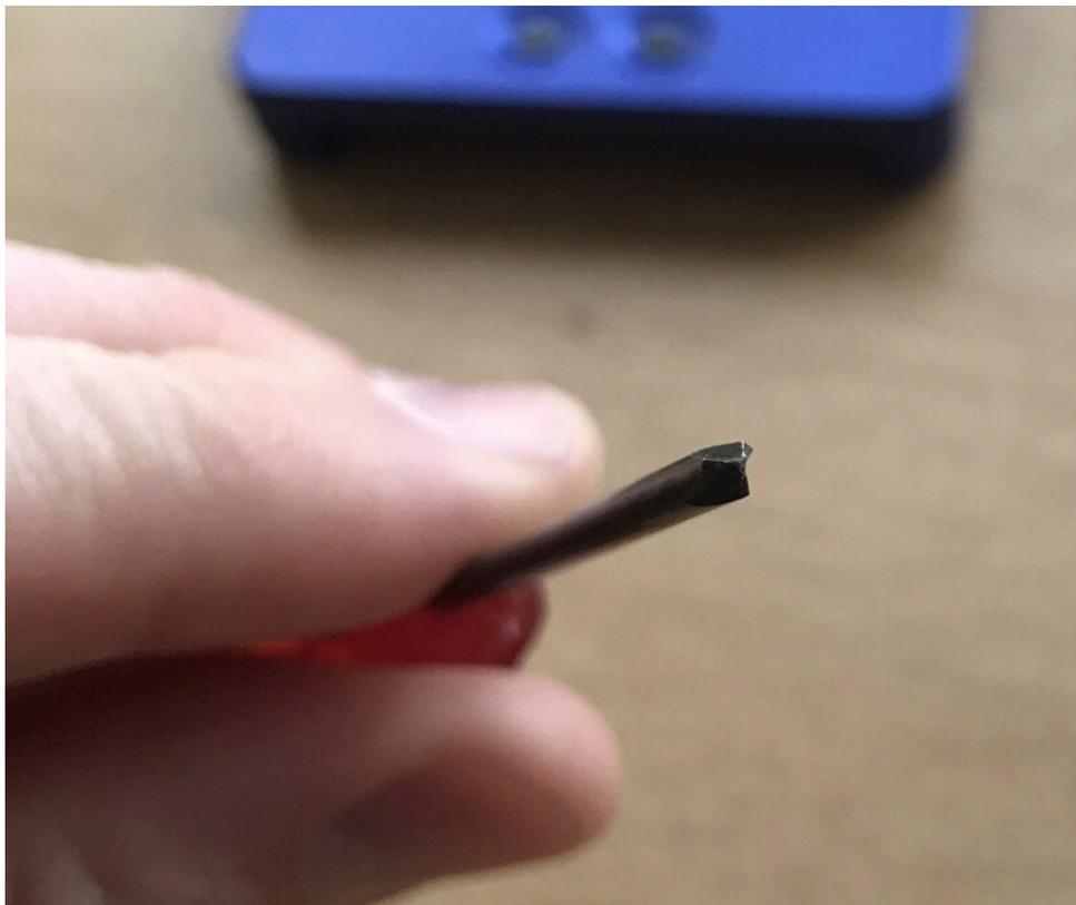
*Usando las herramientas adecuadas: un destornillador triangular Tri-wing*
