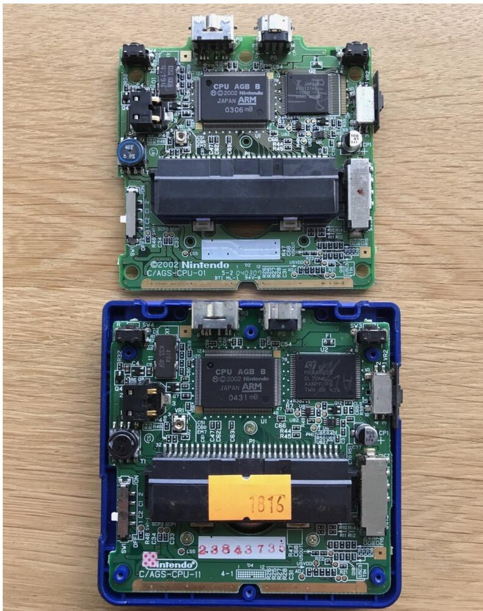
*Encuentra las diferencias: la placa lógica defectuosa original arriba y el reemplazo abajo*
