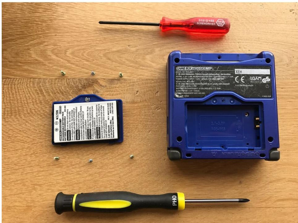
*Coloca los tornillos alrededor de algo fácil de reconocer (la batería) para llevar un registro fácil de dónde deben ir los (diferentes) tornillos*
