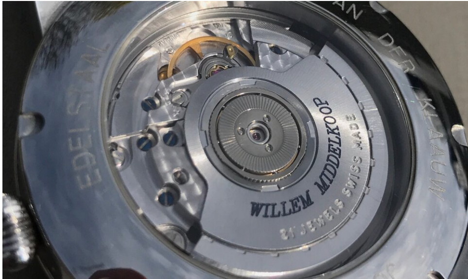
El rotor de cuerda y el movimiento del reloj mecánico, visibles a través del fondo de caja de zafiro
