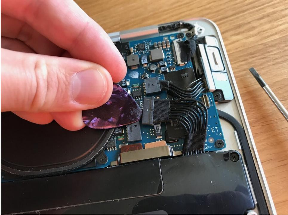
*Desconecté la batería de la placa lógica usando una herramienta de plástico (que no conduce electricidad).*
