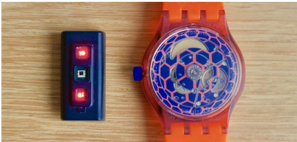
*En la parte inferior se pueden ver los dos LED rojos y el sensor PPG. Al igual que el movimiento del Swatch Sistem51, esto queda oculto cuando se lleva en la muñeca.*
