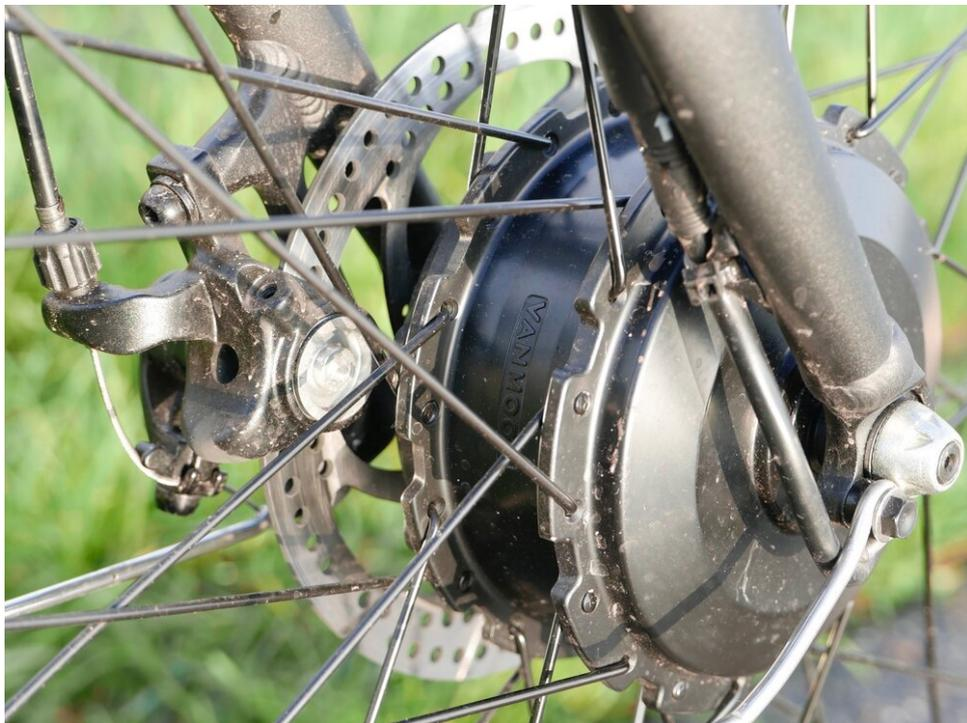
*Motor eléctrico en el buje delantero*
