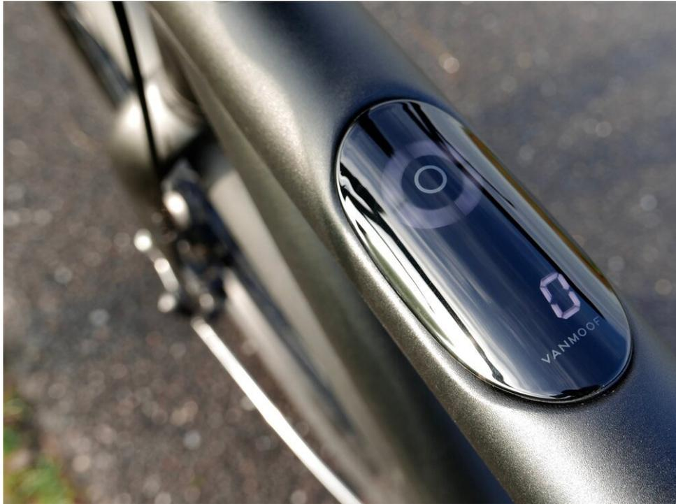
*El tablero indica la velocidad actual, el nivel de la batería y el rendimiento del motor*
