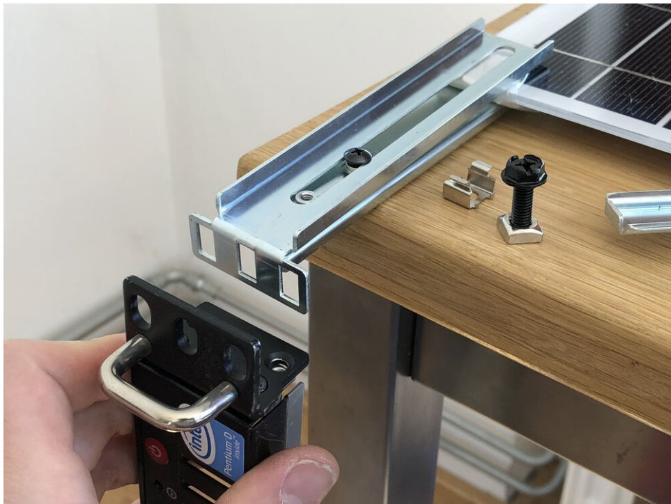
Anteriormente el frontal de un servidor, ahora parte del soporte de montaje del panel solar
