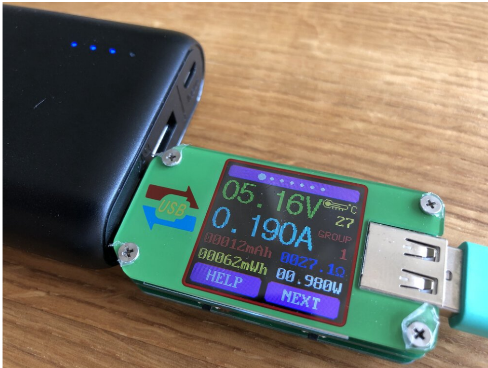
Midiendo el consumo de energía con un monitor de energía USB en línea
