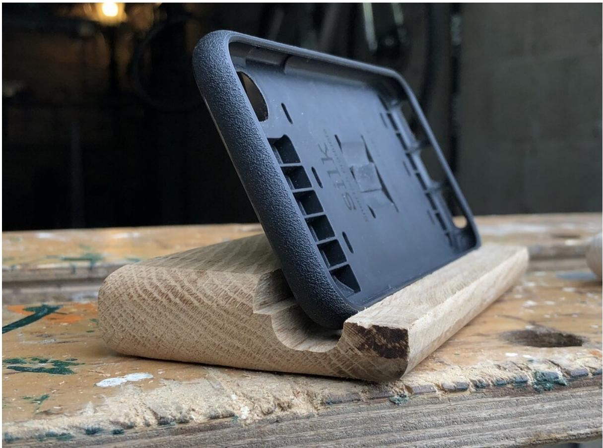
Hoy he creado un soporte minimalista para iPhone de madera de roble. Aunque es mucho más rápido comprar uno online, quería uno que se ajustara a mi teléfono horizontalmente, con la funda puesta. Me gusta el diseño minimalista, así que opté por mecanizar una sola pieza de madera para hacerlo.
