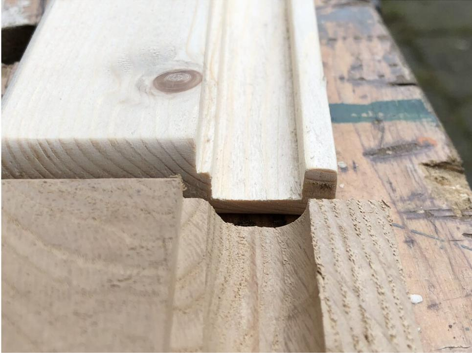
*Comparando el perfil de fresado del prototipo con la versión final*
