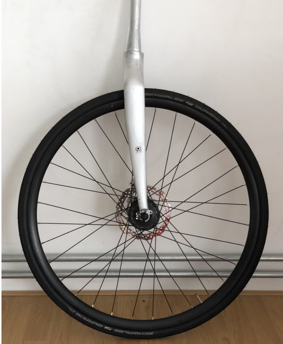
Rueda delantera montada en la horquilla de aluminio en bruto
