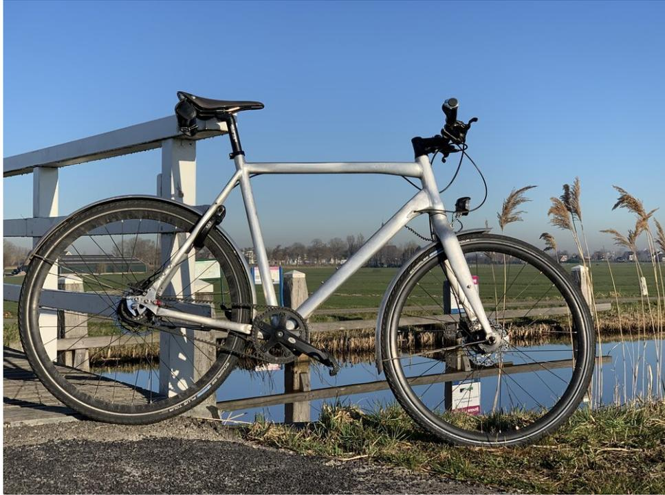
*Mi bici de cercanías, una Sensa Cintura modificada con transmisión por correa Gates Carbon Drive CDN/CDX, Shimano Alfine y una dirección Schindelhauer*
