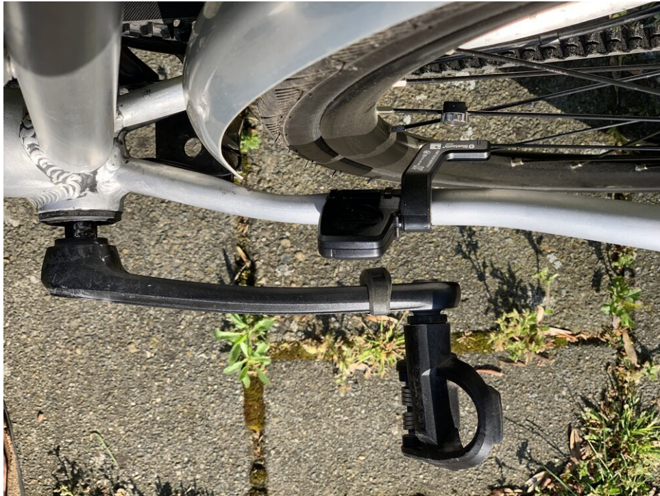
El sensor combinado de velocidad y cadencia montado en mi bicicleta
