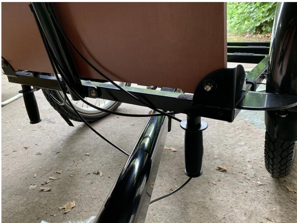
*Asegúrate de probar el balanceo de la caja de carga una vez que hayas fijado los cables*
