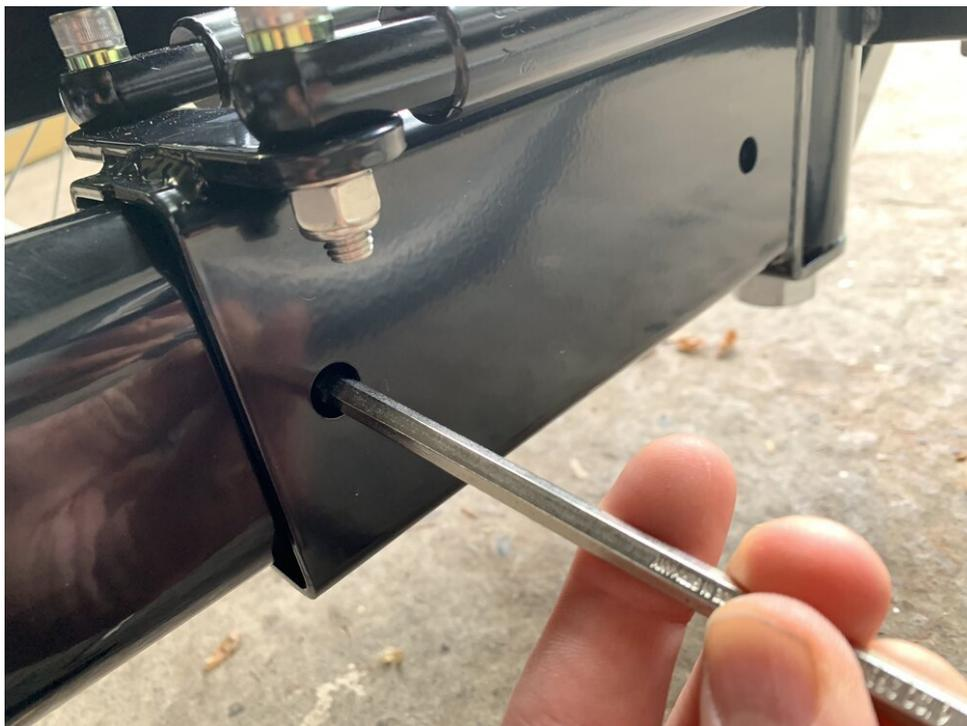
*Usando una llave hexagonal para empujar la placa de relleno a su posición, liberando el orificio del perno*
