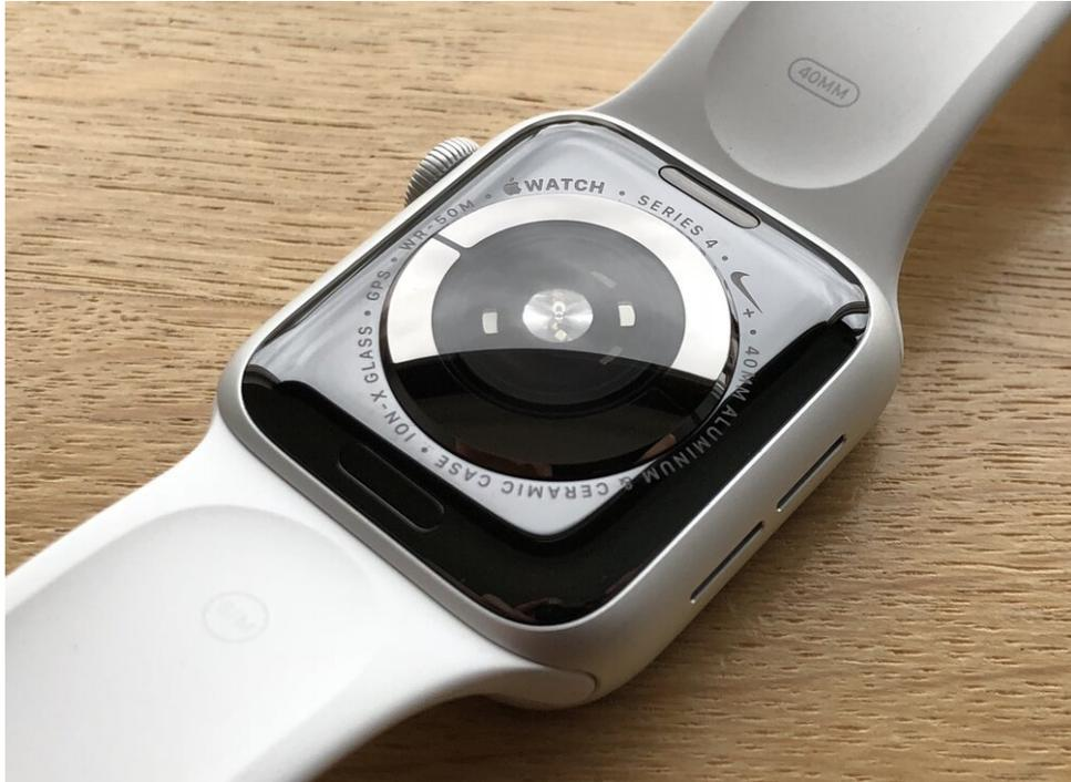
*Apple Watch utiliza un sensor óptico para realizar su monitorización automática del ritmo cardíaco*
