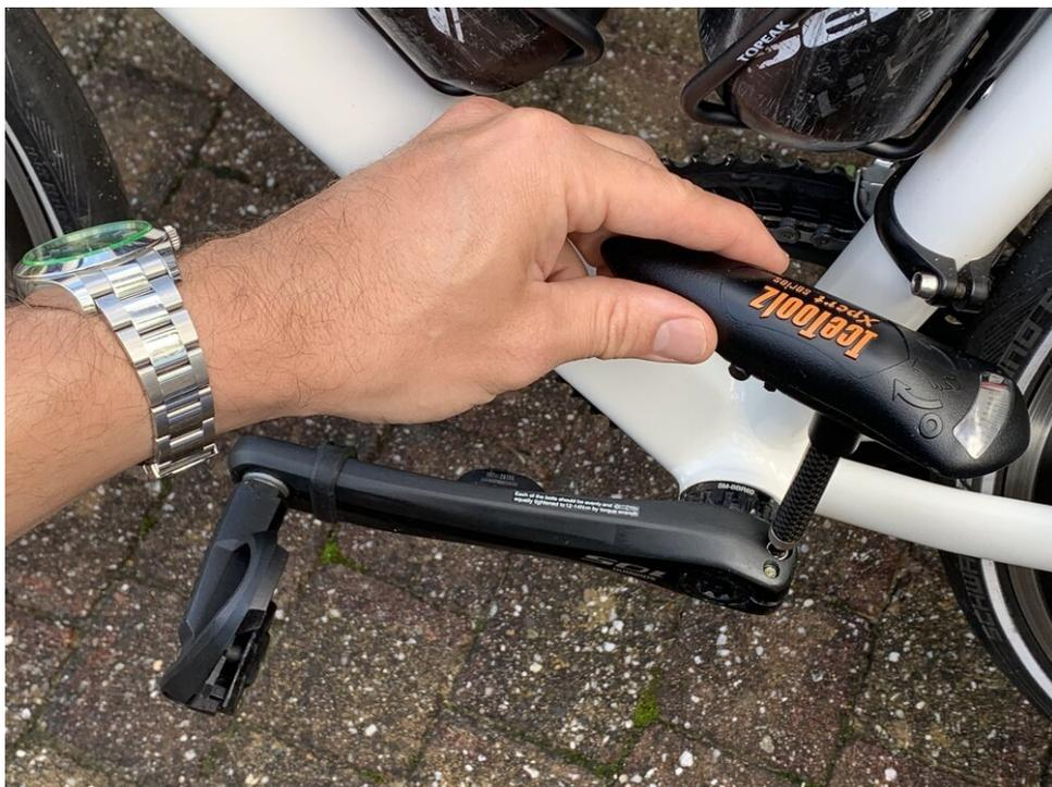
*Aprietando la biela con una llave dinamométrica*
