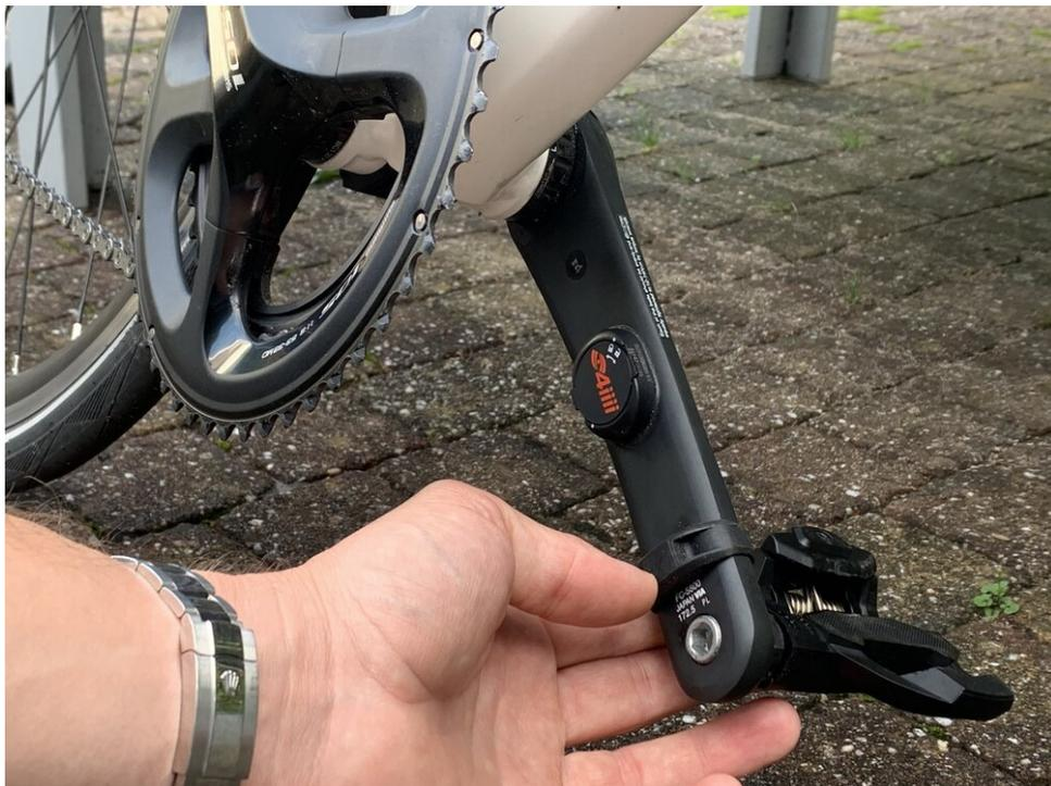
*Medidor de potencia 4iiii Precision instalado en mi bicicleta*
