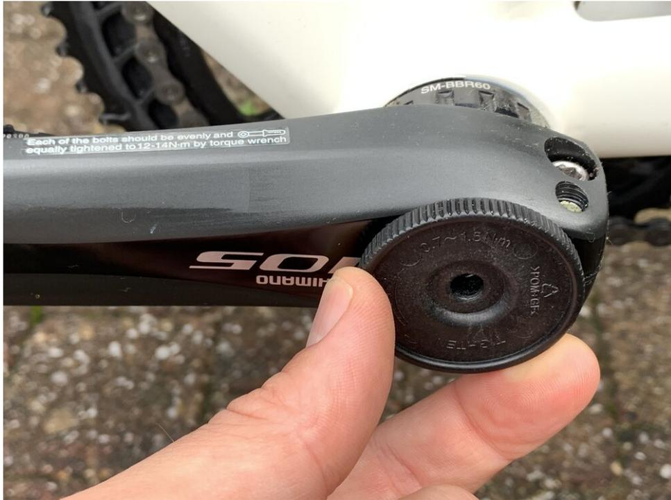
*Debería poder aflojar la tapa de plástico solo con los dedos/la mano, no se requiere un par extremo*
