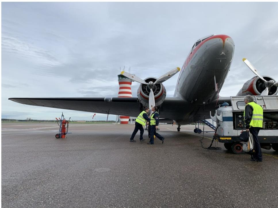
*Voluntarios preparando los motores de avión Pratt & Whitney R-1830 Twin Wasp para el encendido*
