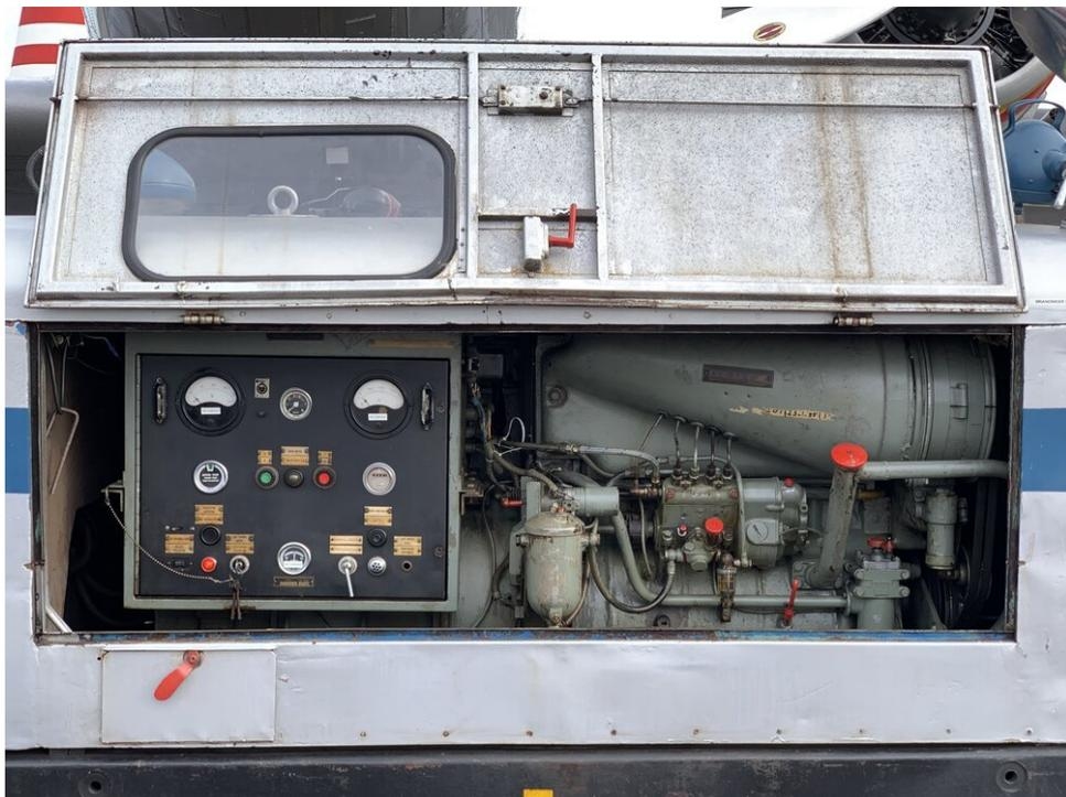
*Panel de control del generador eléctrico dentro del vagón plataforma*
