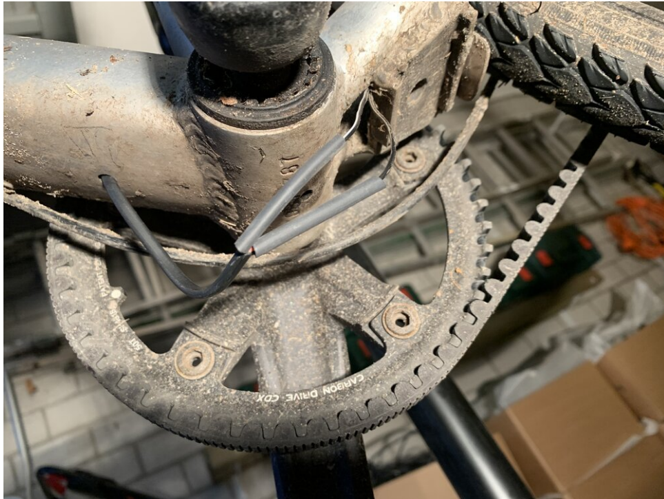
Conexión de la luz trasera a la luz delantera, protegiendo la unión con fundas termoretráctiles
