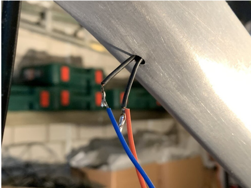
Cable nuevo soldado al antiguo, lo que permite tirar del nuevo a través del cuadro de la bicicleta
