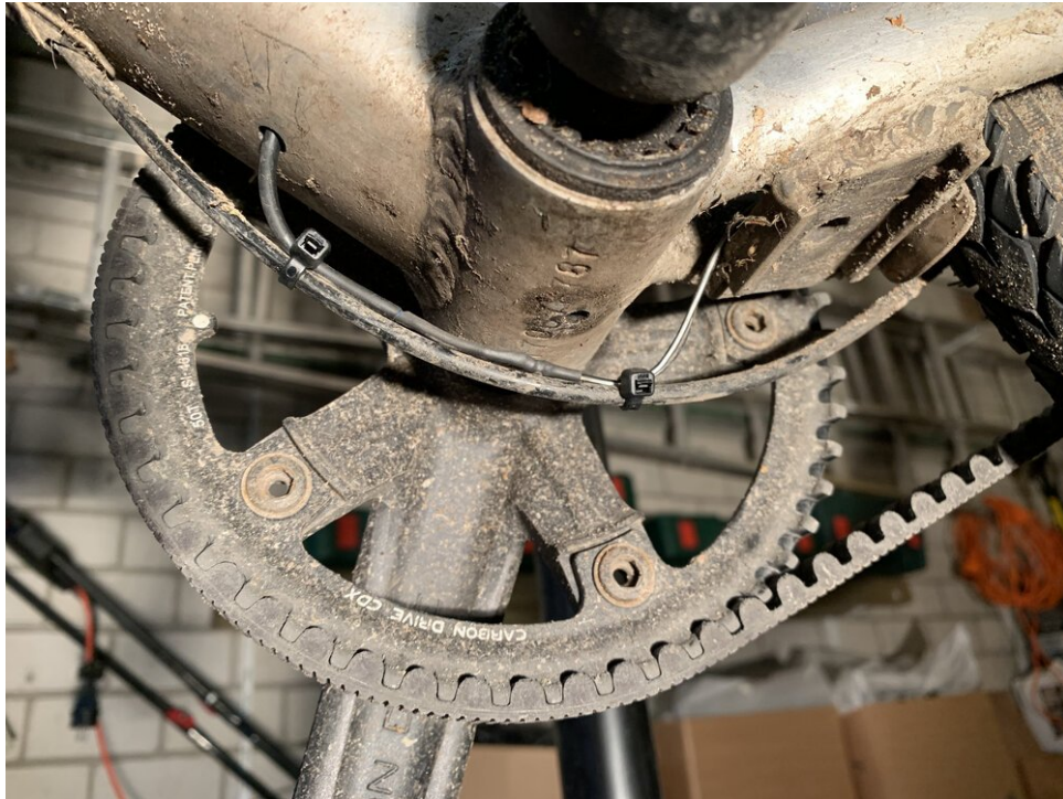
Sujetando el cable eléctrico al cable de cambio más resistente con bridas
