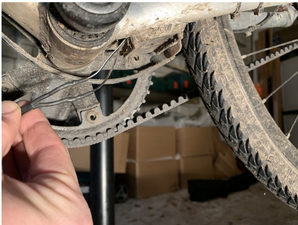
Después de calentar las fundas termoretráctiles, proporcionarán una capa protectora contra los elementos
