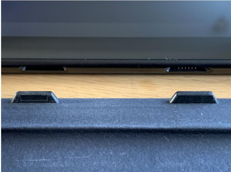
*El teclado se conecta mediante un conector magnético que también proporciona alimentación y conectividad (no se requiere una batería o configuración de conexión por separado)*
