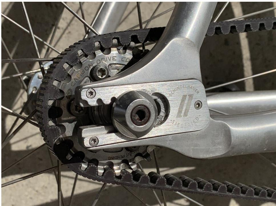
*La rueda trasera se fija mediante un sistema tensor de correa de 'cocodrilo'*
