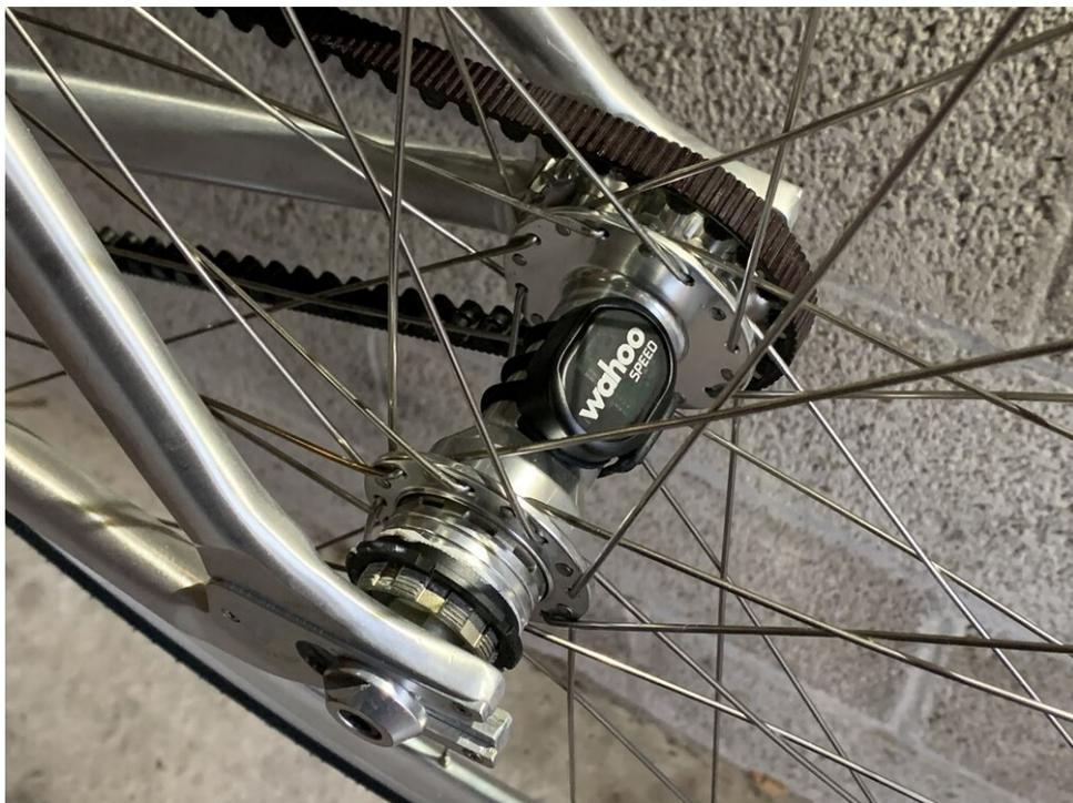
*El sensor de velocidad Wahoo instalado en el buje trasero flip-flop*
