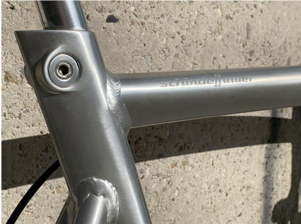
*La abrazadera de la tija de sillín está integrada en el minimalista cuadro de aluminio AL6061-T6 con tubos aerodinámicos de triple conificado*
