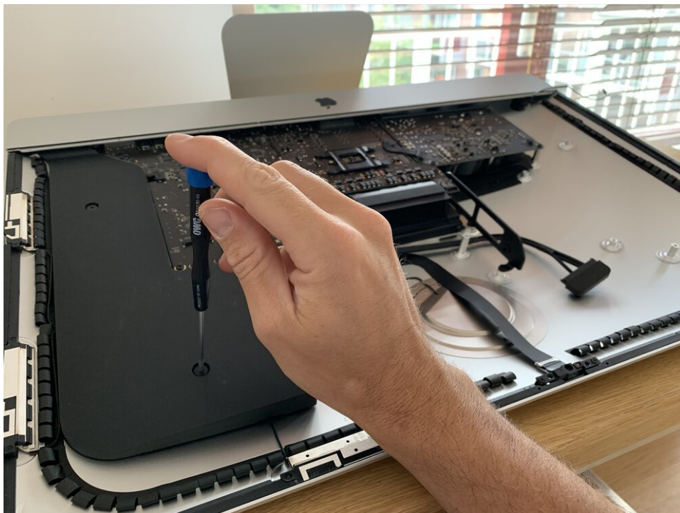
Retirando el otro altavoz del iMac
