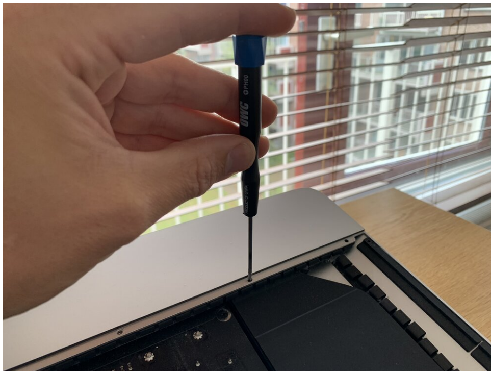
Retirando los tornillos del iMac
