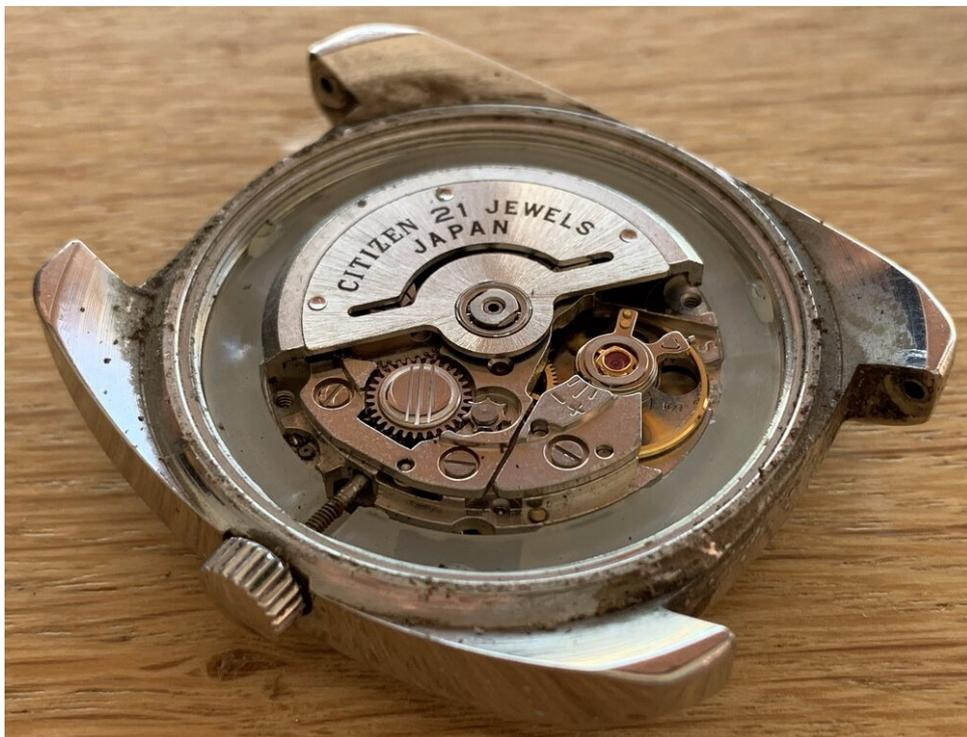
*Hay un rotor que da cuerda al reloj cuando se mueve (en la muñeca), un sistema inteligente que elimina la necesidad de pilas*
