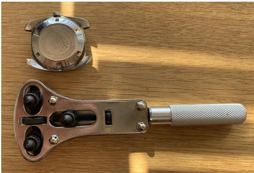
*Abrir el reloj se puede hacer usando una herramienta especial*
