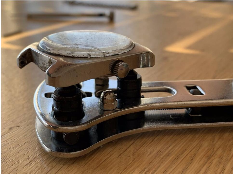
*Ajusta la herramienta para que coincida con los puntos de montaje de la tapa trasera, para permitir que la gire y la abra*
