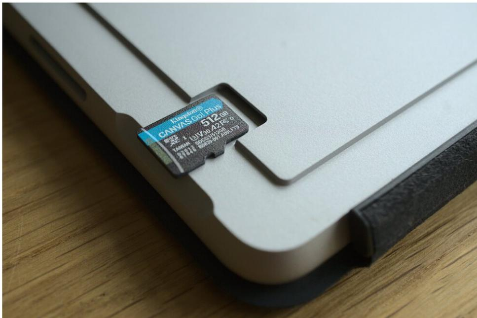
*Ampliar el almacenamiento en un Surface Go 2 es posible usando una tarjeta MicroSD*
