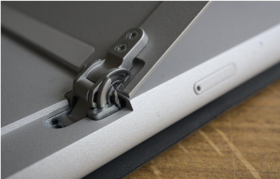
*El soporte es muy resistente ya que utiliza dos fuertes bisagras de metal*
