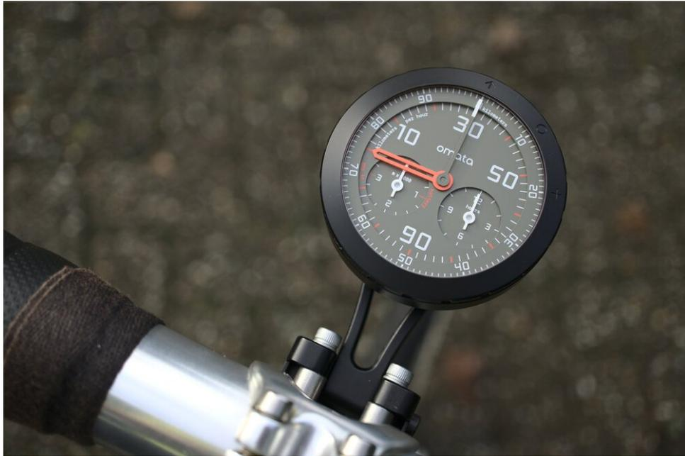
*El Omata One utiliza cuatro manecillas mecánicas para indicar la velocidad (naranja), la distancia (anillo exterior), el ascenso (izquierda) y el tiempo transcurrido (derecha)*
