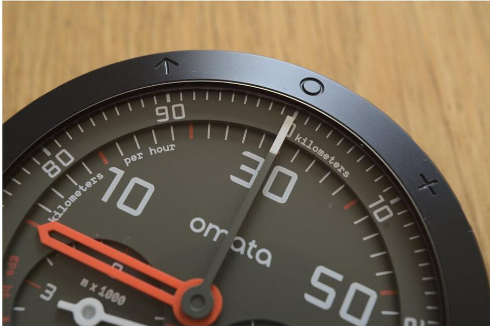
*El Omata One se opera mediante el anillo exterior que funciona como selector*
