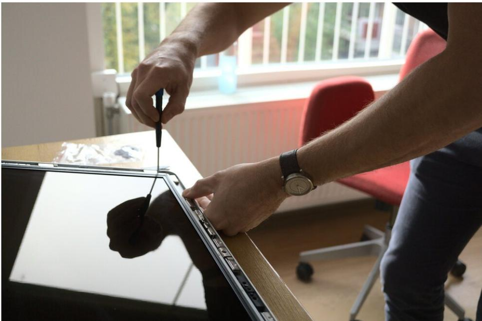
*La pantalla está fijada con tornillos Torx - ¡puede ser un poco complicado retirar los tornillos ya que los imanes los atrapan fácilmente!*
