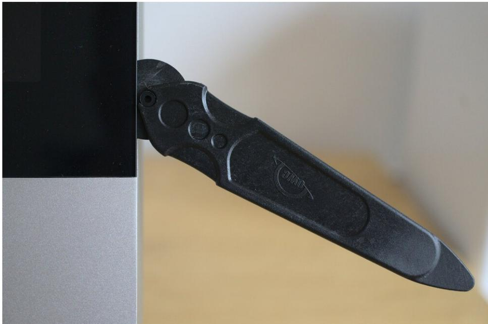
*Algunos iMacs requieren una cuchilla especial para cortar la cinta adhesiva que sujeta el cristal al marco de aluminio*
