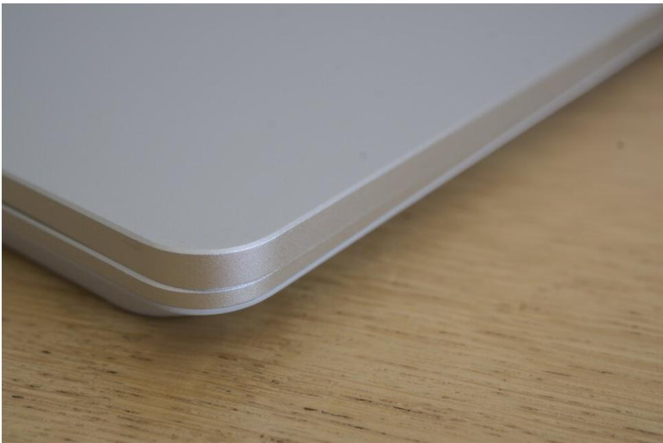
*El portátil está hecho de aluminio y plástico, moldeados juntos como una sola pieza.*
