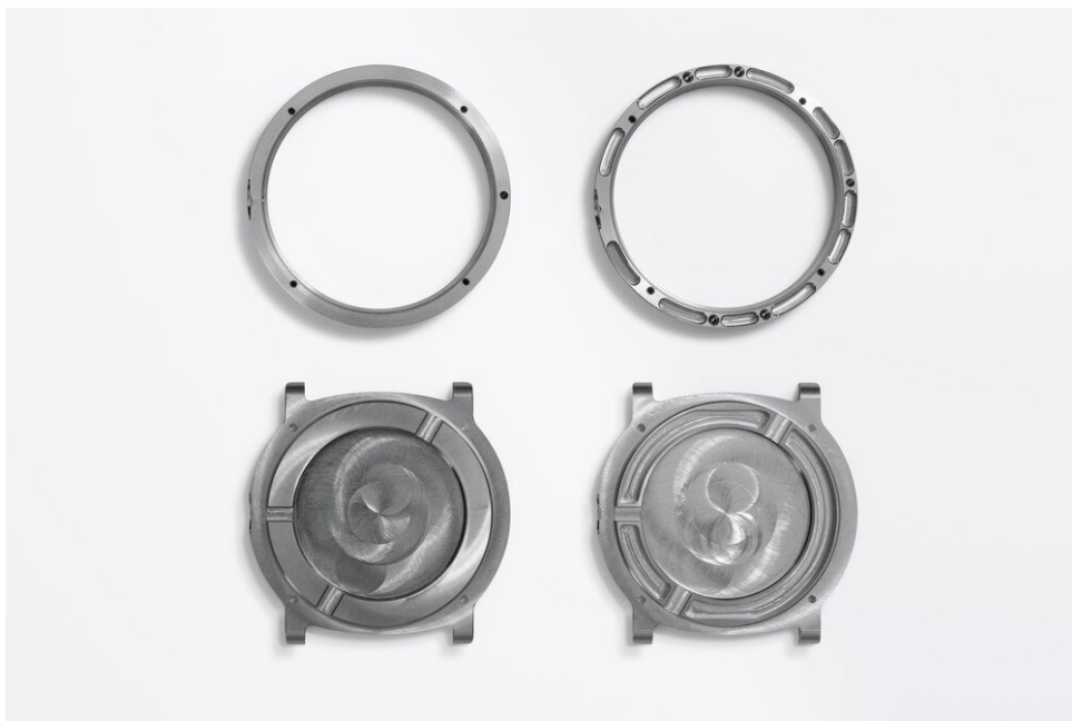
Antes (izquierda) y después (derecha) de fresar el material
